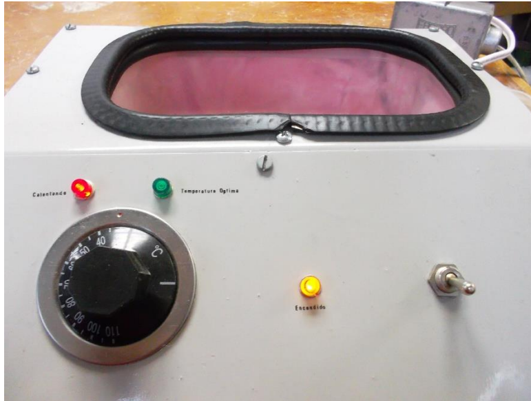
Figura 9 Baño con termostato incorporado donde se llevó a cabo la escarificación térmica.
