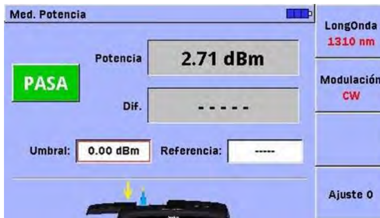
Figura 27. Potencia de Tx (Upstream) del ONT en casa 1 a 1310 [nm]
