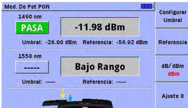
Figura 29. Potencia de Rx (Downstream) del ONT en casa 1 a 1490 [nm]
