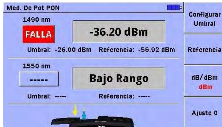
Figura 42. Potencia de Rx (Downstream) del ONT en casa 7 a 1490 [nm]
