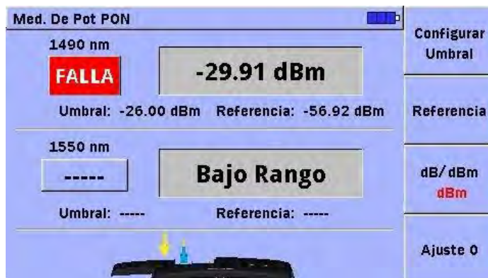
Figura 39. Potencia de Rx (Downstream) del ONT en casa 6 a 1490 [nm]
