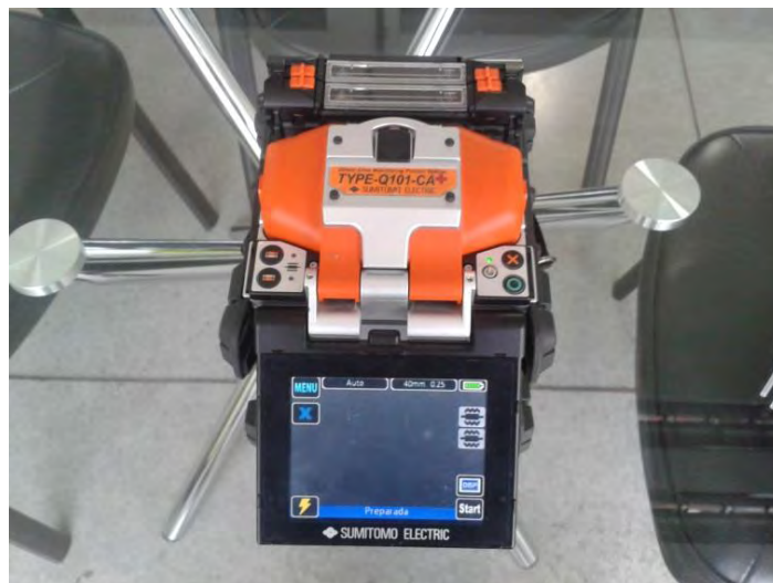
Figura 8. Empalmadora de fusión por alineación de núcleo
