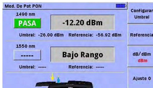
Figura 44. Potencia de Rx (Downstream) del ONT en casa 7 a 1490 [nm] luego de reparado el corte
