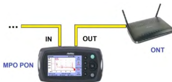
Figura 28. Configuración de conexiones para medir recepción en ONT
