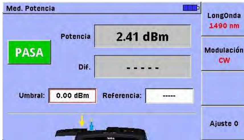
Figura 16. Potencia de Tx (Downstream) del OLT a 1490 [nm]
