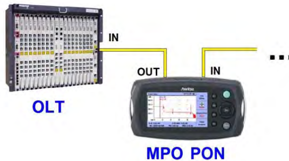
Figura 17. Configuración de conexiones para la prueba de Rx del OLT
