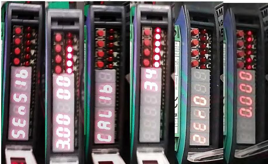
**Figura 4.3.1.6** proceso de calibración para el transductor TLB Laumas
