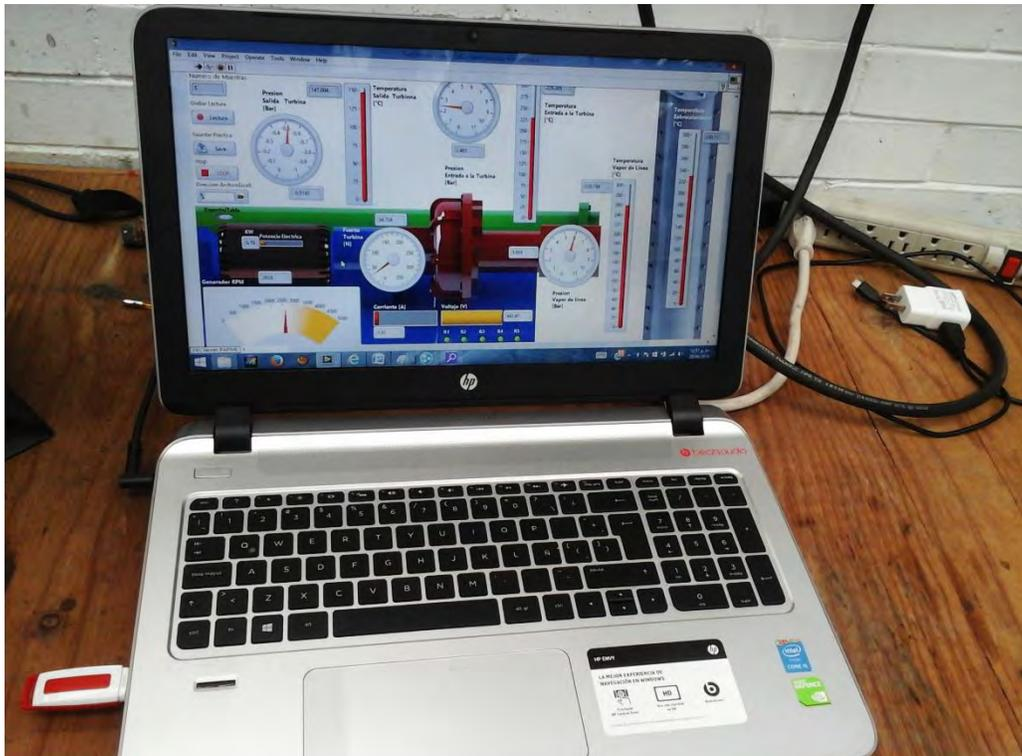
**Figura 5.2.2** Interfaz principal para Turbina COPPUS en laptop
