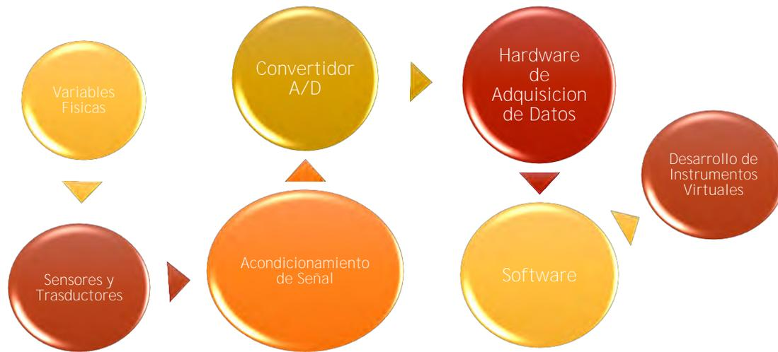
**Figura 3.1.2** Elementos de un Sistema de Medición e Instrumentación Virtual.
