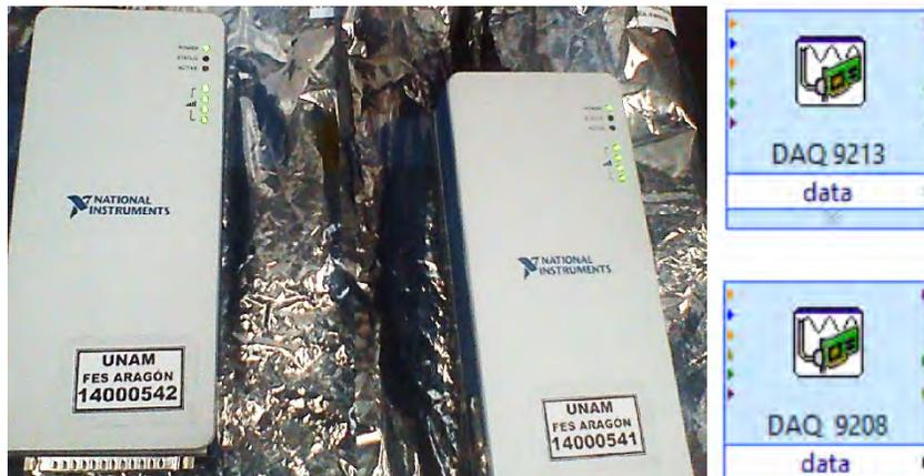
Figura 4.2.3.1 DAQs conectadas vía WI Fi con sus VI Express
