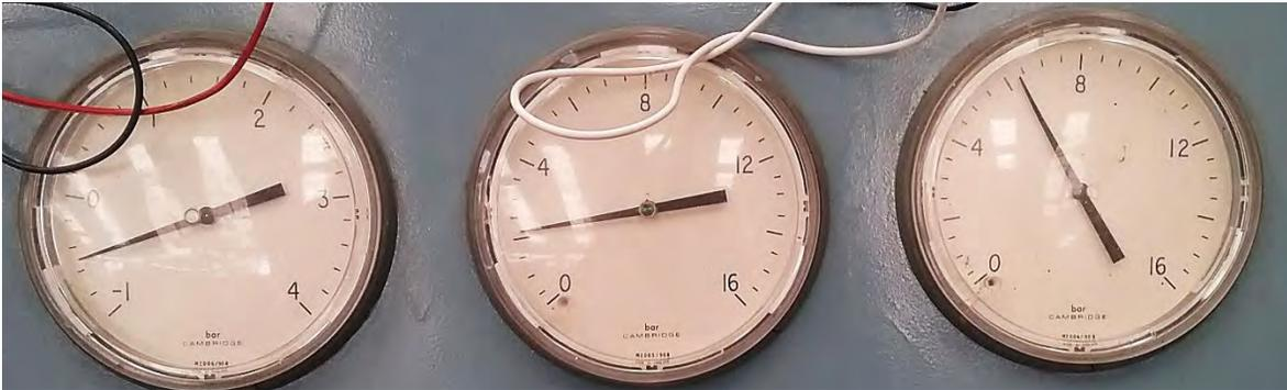
**Figura 5.1.1** Presión Salida de turbina, Presión entrada de turbina Presión vapor de línea
