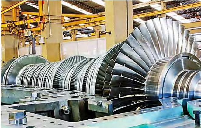
**Figura 2.1.1** Turbina de Vapor Industrial. (TGM,s.f.)
