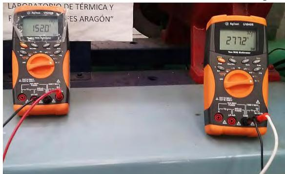
**Figura 5.1.6.** Temperatura de salida de turbina y Vapor de línea.
