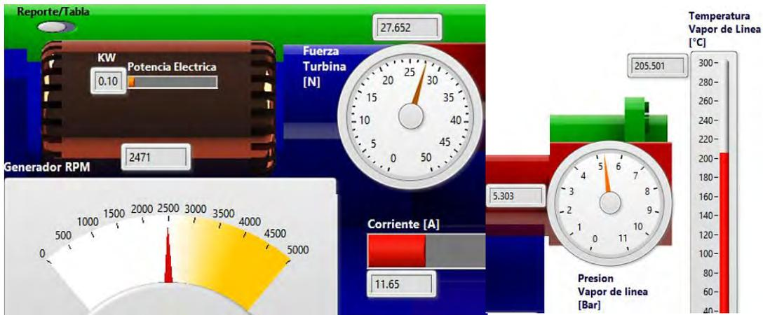
**Figura 5.2.5** mediciones de velocidad en RPM, Fuerza en N, Temperatura y presión de línea
