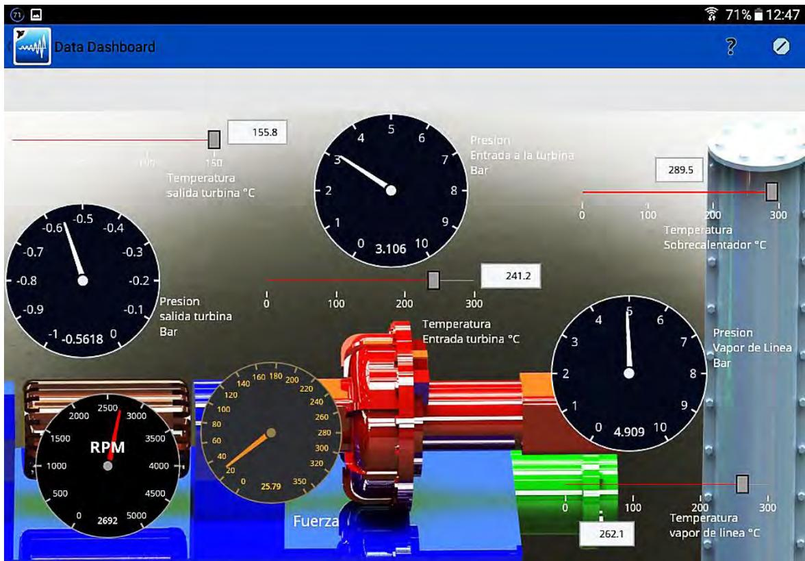
**Figura 5.2.7** Interfaz para Dispositivos móviles adquiriendo datos de todos los sensores
