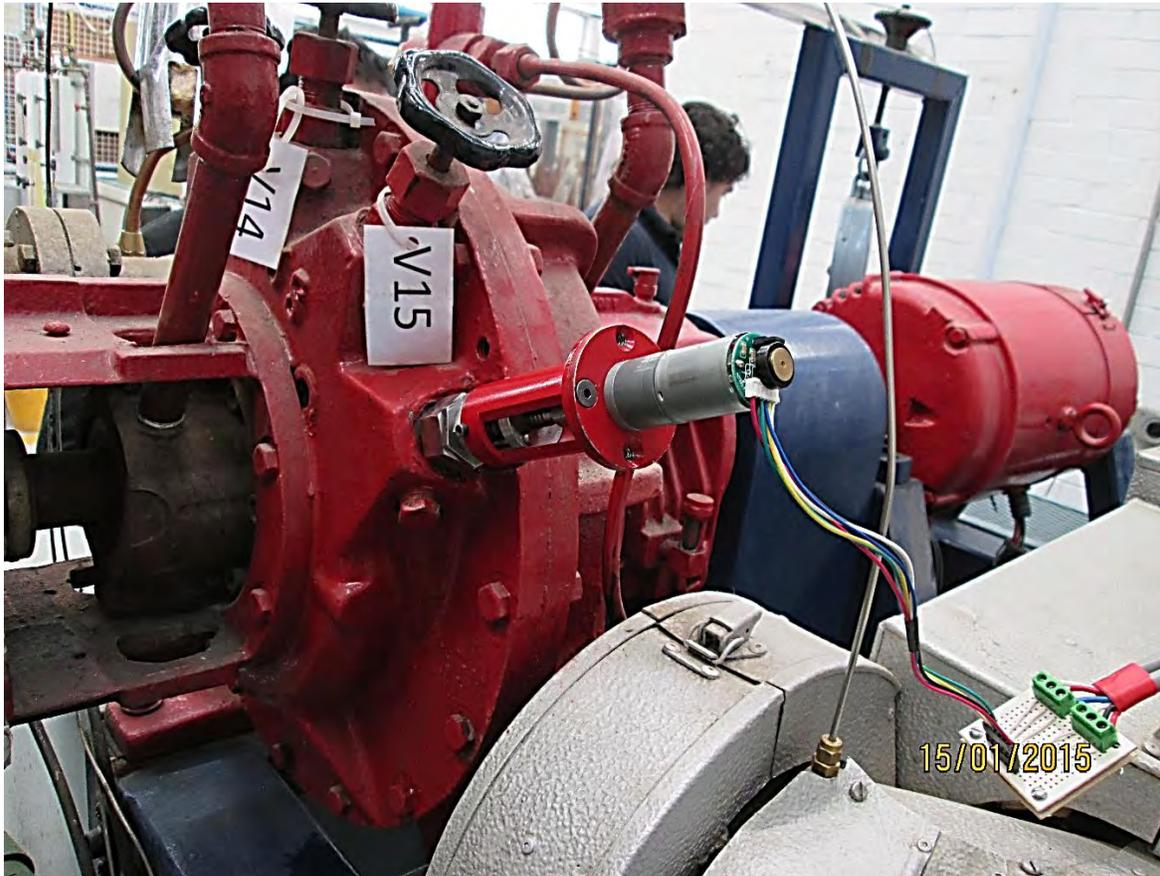
**Figura 1.3.1** Servovalvula montada en la Turbina COPPUS. [2]
