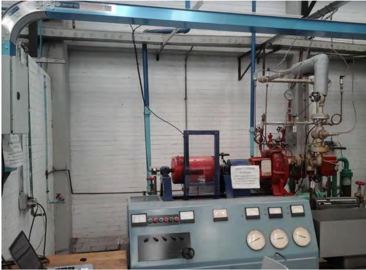
Se realizaron las conexiones de los sensores dentro del armario de control y se instaló en el laboratorio de máquinas térmicas junto con las canaletas porta cables de los sensores de la Turbina COPPUS. Se realizaron diversas prácticas para supervisar en la computadora y en dispositivos móviles portátiles la evolución de los procesos de la turbina COPPUS adquiriendo Temperaturas, Presiones, Velocidad y carga en tiempo real
