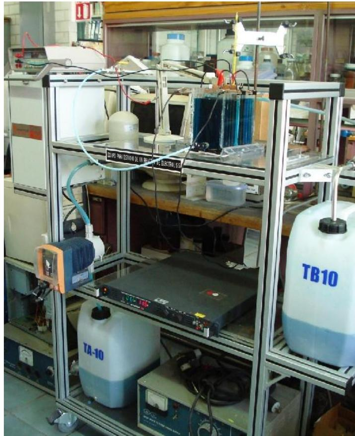
**Figura 37.** Equipo de electrólisis para el electrodeposición de Cobre.
