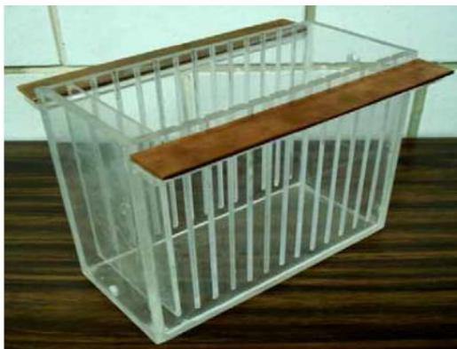
**Figura 37.** Reactor de placas paralelas de flujo continuo para el electrodeposición de cobre.
