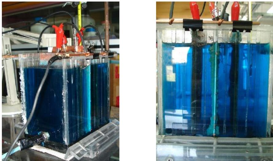
**Figura 38.** Reactor de placas paralelas operando con el electrodeposición de cobre.
