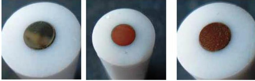
**Figura 10.** Electrodo para pruebas de voltamperometría cíclica. A) Electrodo de acero. B) Depósito de Cobre obtenido mediante barrido a 5 mV/s. C) Depósito de Cobre obtenido mediante barrido a 500 mV/s.
