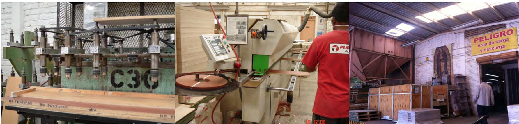
4-Al tener las piezas cortadas, se pasan por un taladro múltiple con escantillones donde se ajustan manualmente pieza por pieza para realizar varios barrenos simultáneamente, logrando elevar la producción en un tiempo más corto (esta máquina es un diseño exclusivo de la propia empresa).
