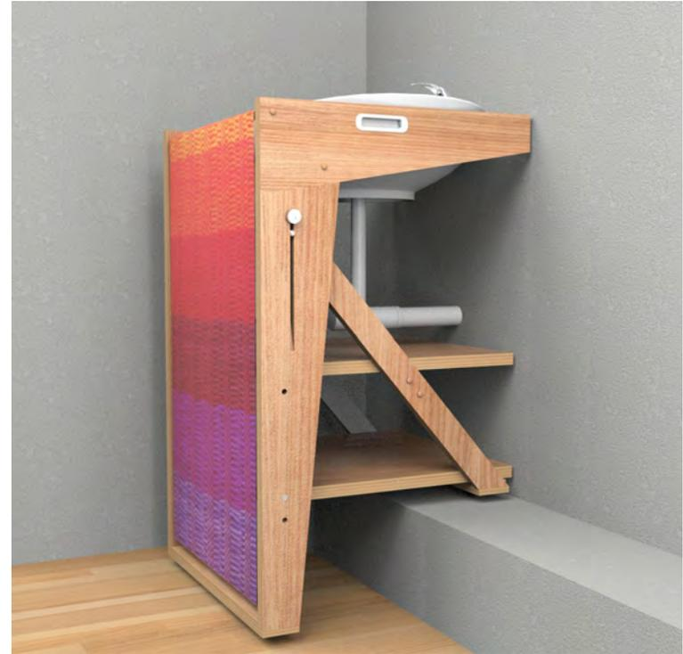
El mecanismo para ajustar los entrepaños, resuelve el problema que se tenía con el céspol y el escalón del baño (como se muestra en los dos ejemplos), demostrando que los entrepaños no chocan con ninguna instalación y permite un área para el guardado de varios objetos.
