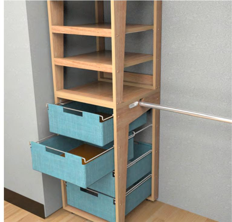
Para evitar el uso de correderas convencionales se utilizaron unos soportes metálicos en forma de C para soportar los entrepaños o los cajones, de esta manera se facilita la extracción de estos elementos, además tienen la segunda función de darle estructura a los laterales del módulo. Con este sistema el usuario tiene la opción de elegir dónde colocar los entrepaños o los cajones e incluso hacer combinaciones.
