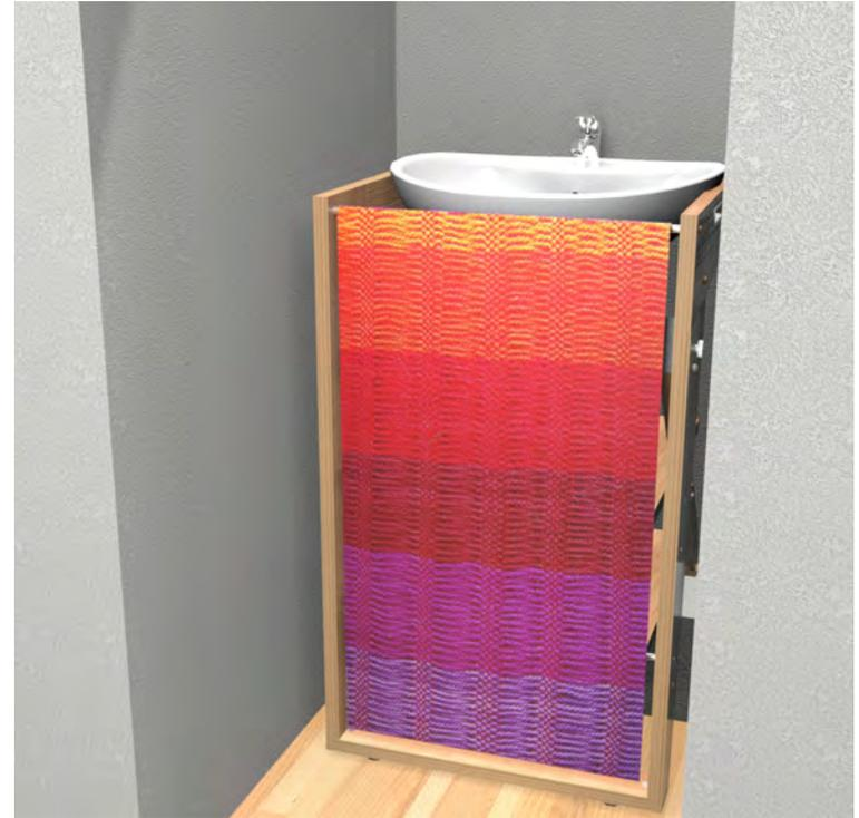
Cabe mencionar que el diseño del mueble permite instalarlo debajo de las dos tarjas, puesto que ambas piezas comerciales tienen dimensiones similares y son de la misma marca para todas las viviendas. El módulo abraza por la parte inferior la tarja lo que permite que se pueda colocar hasta encontrarse con la pared.
