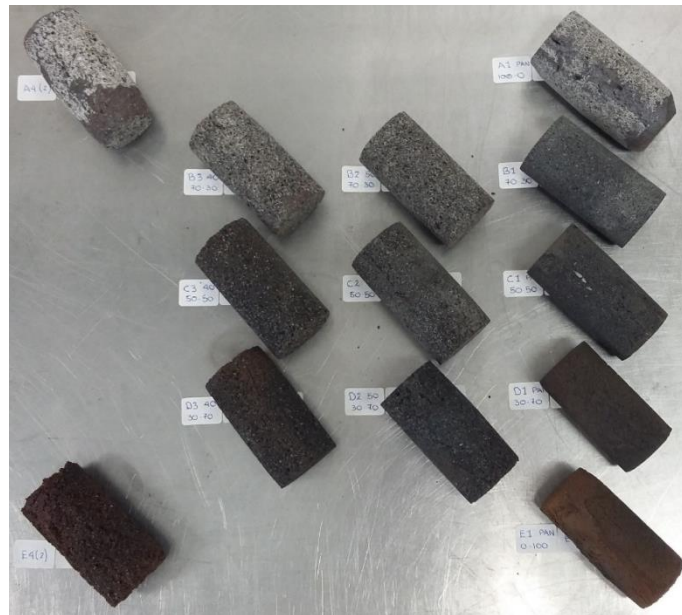
Figura A.7. Monolitos vitrocerámicos empleados en el diseño de superficie de respuesta. De izquierda a derecha, comenzando por la fila superior: A4, A1, B3, B2, B1, C3, C2, C1, D3, D2, D1, E4 y E1.
