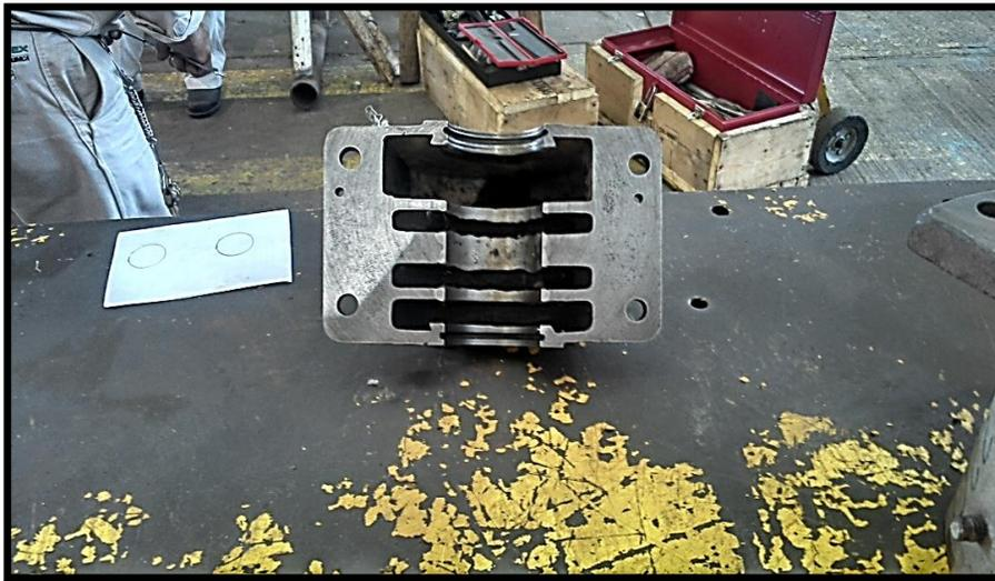
**Imagen 7. Carcasa de turbina de vapor.**
