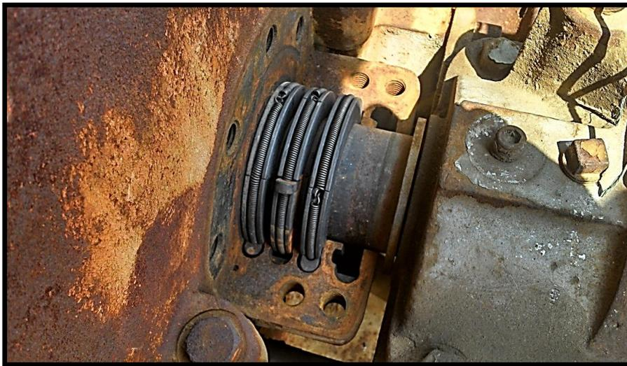
**Imagen 14. Sellos de carbón montados en la turbina.**
