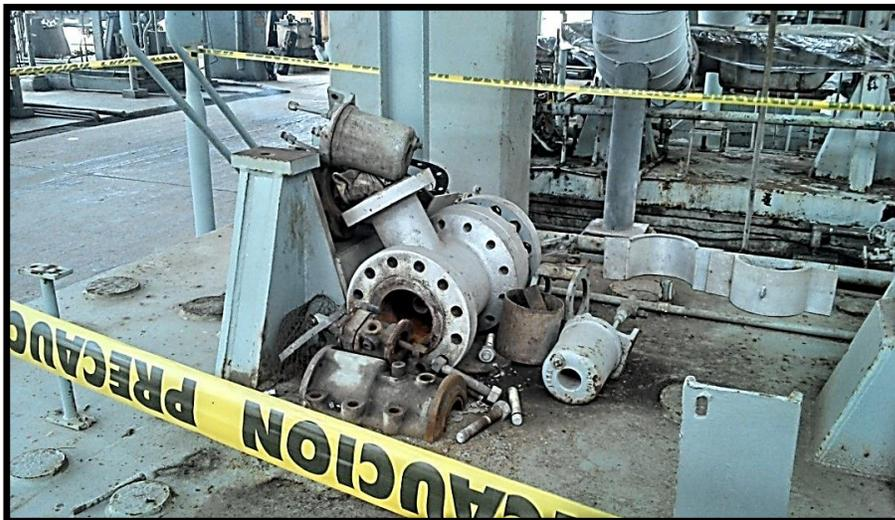
**Imagen 32. Parte de la carcasa que cubre la parte externa del rotor tirada en el piso.**
