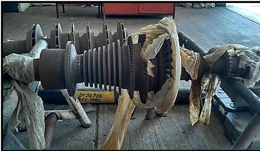
**Imagen 5. Rotor de una turbina de vapor de alta carga.**
