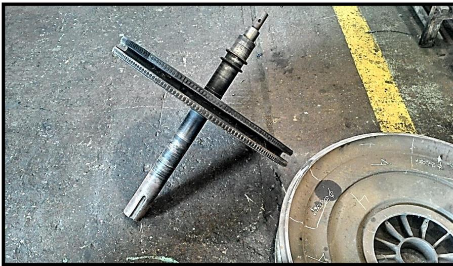
**Imagen 6. Rotor de una turbina de vapor de baja potencia.**
