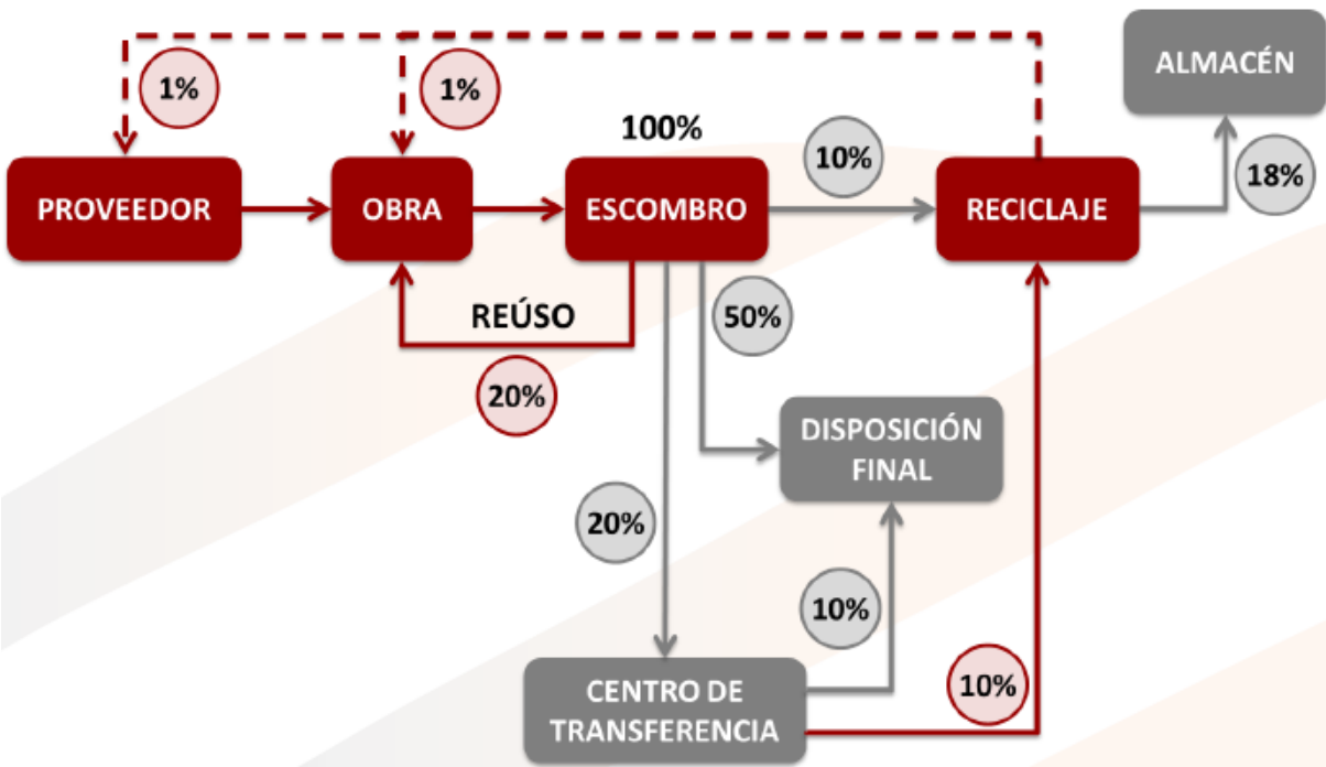
Ilustración 2.3. Ciclo de vida de escombros. Fuente: Cámara Mexicana de la industria de la Construcción, Plan de Manejo de residuos de la construcción y la demolición.
