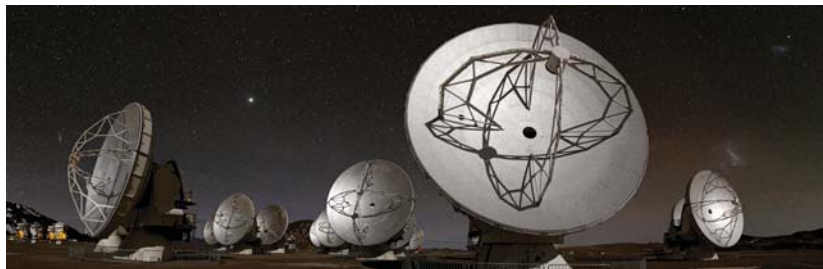
Figura 21: El observatorio ALMA es un arreglo de 66 antenas que funcionará como un interferómetro al combinar las señales de los reflectores de cada antena (para lograr esto se debe tomar en cuenta el tiempo de recorrido de las distintas señales, por tanto la localización de las antenas debe ser estratégica), permitiendo así simular a un enorme telescopio. Los reflectores metálicos captarán radiación de cuerpos astrofísicos con longitudes de onda milimétricas y submilimétricas.
