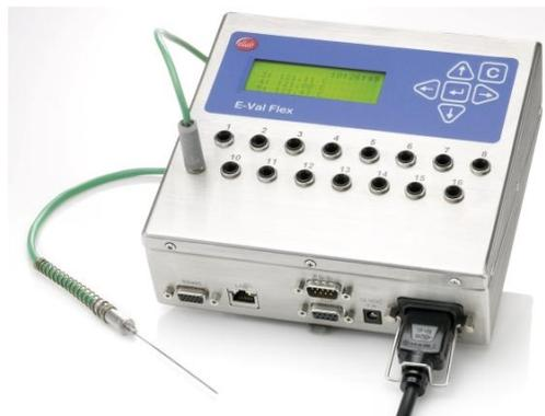
**Figura 16. Módulo de registro E-val flex y sonda termopar tipo T.**
