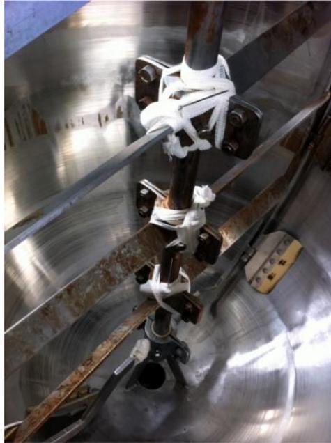
**Figura 22. Fijación de los TMD's (loggers track sense pro) durante el estudio de distribución de temperatura.**
