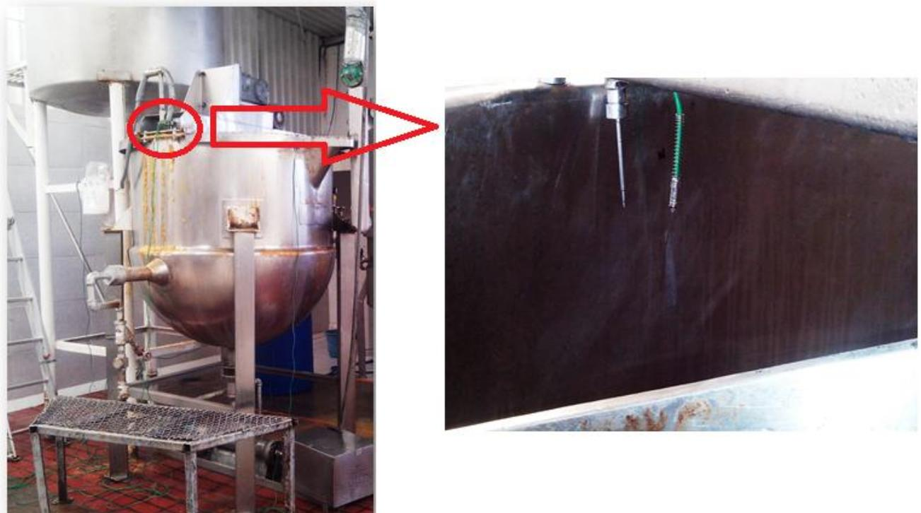
**Figura 21. Sensores Eval Flex y sonda de monitoreo y control.**
