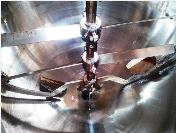
**Figura 19. Montaje de los logger Track Sense Pro en la marmita.**
