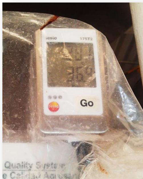
**Figura 30. Dispositivo de medición de temperatura de referencia (TID) marca Testo 175 (utilizado para monitoreo y control del proceso).**
