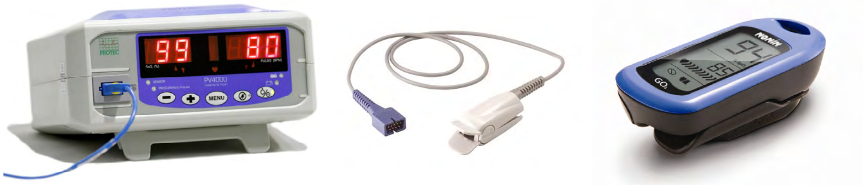
A la izquierda: monitor de un oxímetro hospitalario 33 ; al centro: sensor que se conecta al monitor 34 ; a la derecha: oxímetro portátil 35 .
