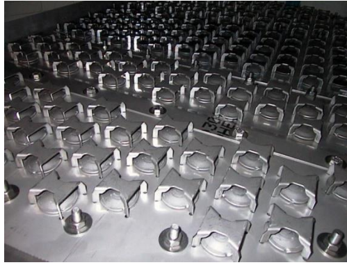
Figura 3. Plato de válvulas.
