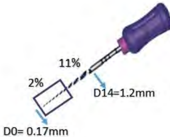
Fig. 42 Conicidad variable del instrumento S1 , D0=0.17 y D14=1.2mm
