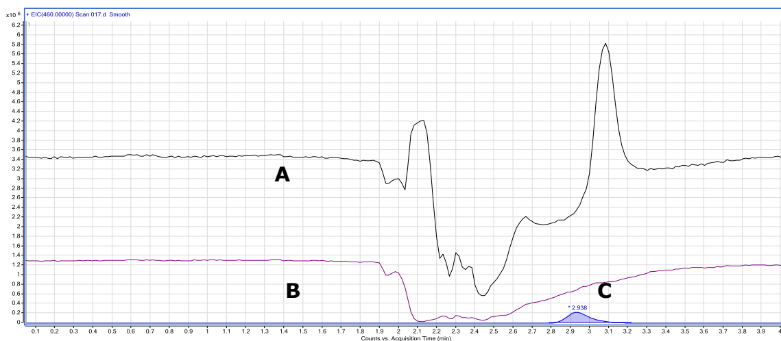
Figura 17. Cromatograma de evaluación de supresión iónica. A Señal de iones totales. B Señal de infusión de CasIII-ia®. C Señal de CasIII-ia en plasma.
