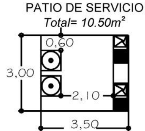
Diagrama 16. Medidas mínimas del patio de servicio.
