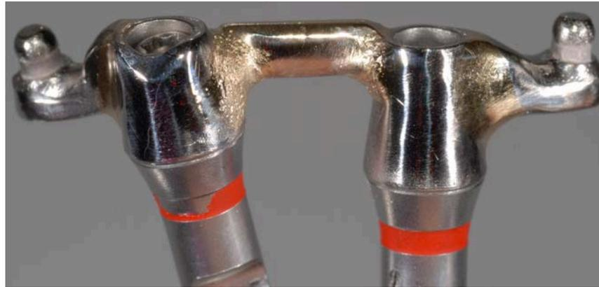
Fig.24 Barra dolder con componentes de oro prefabricados y puntos de soldadura para unir las partes.<sup>12</sup>
