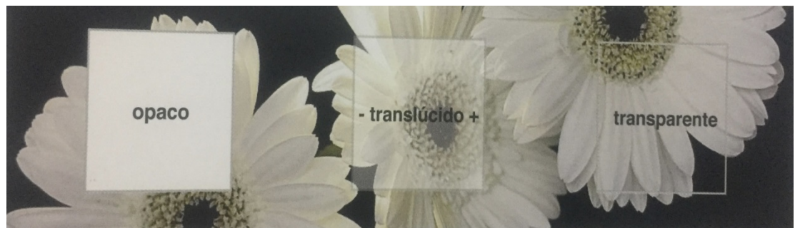
Fig. 35. Se observan las diferentes características de los fenómenos de reflexión/transmisión de la luz.
