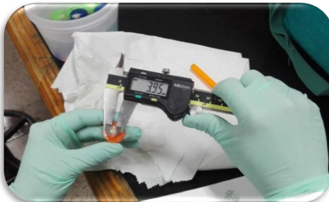
Figura 46. Toma de medidas de los diámetros con vernier digital
