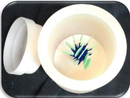
Figura 10. Cubilete de silicón con muestras de cera
