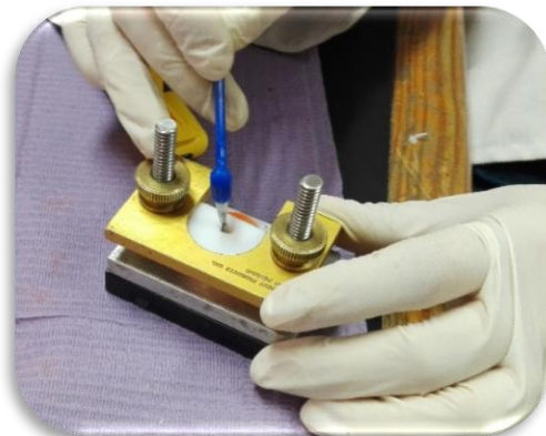
Figura 38. Aplicación de cemento dual sobre la muestra
