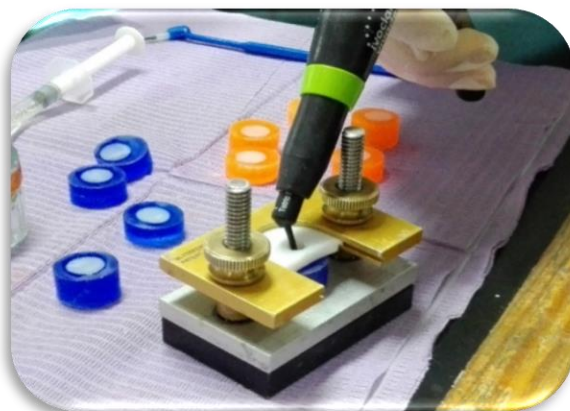
Figura 40. Aplicación de resina fluida Tetric N-Flow sobre la muestra
