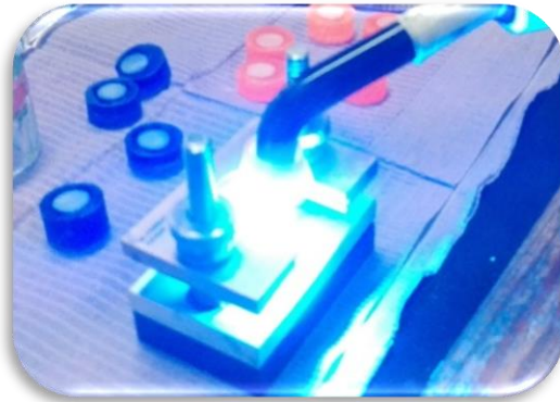
Figura 42. Fotopolimerización de la resina fluida
