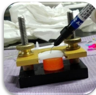
Figura 41. Aplicación de resina fluida Filtek Z350
