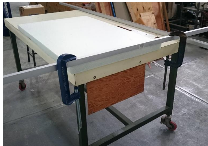
Fig. 3.26. Corte del aislante térmico.
