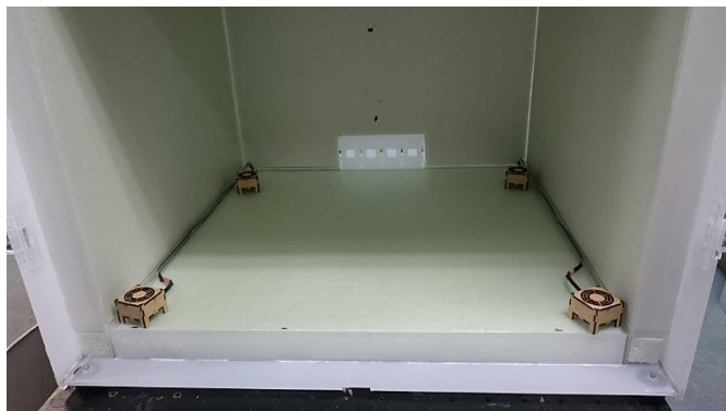
Fig. 3.35. Ubicación de los calefactores dentro de la cámara.
