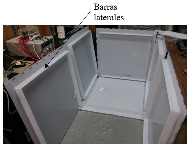
Fig. 3.24 Paredes de la cámara.
