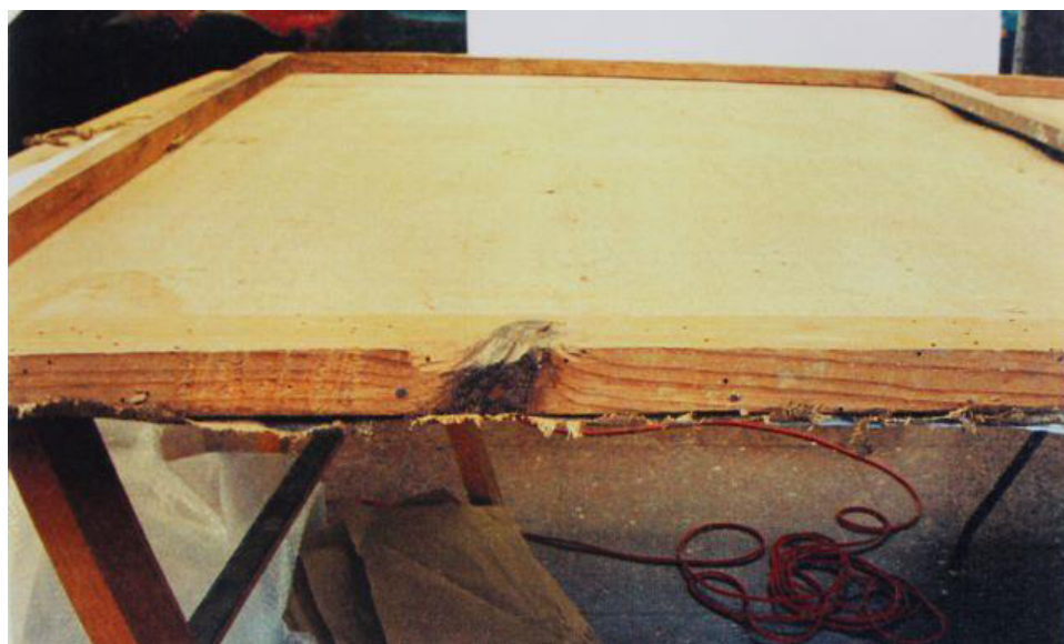
Fig. 98 Detalle del larguero izquierdo del bastidor de Presentación de Jesús en el templo en donde puede verse un gran nudo que ocasionó problemas en la estructura. Tomado de Desireé Escobar Jordá y Claudia Alejandra Sánchez Gándara. Informe acerca del cuadro: "La presentación del niño Jesús en el Templo", México, ENCRyM- INAH, 1999, s/p.
