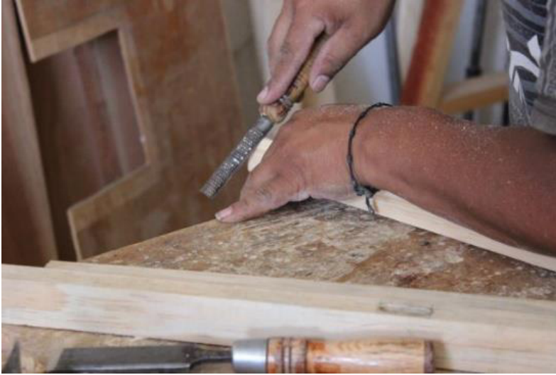
Fig.52 Uso de escofina para eliminar astillas y rebaba de la espiga. Fotografía de Elizabeth Vite
