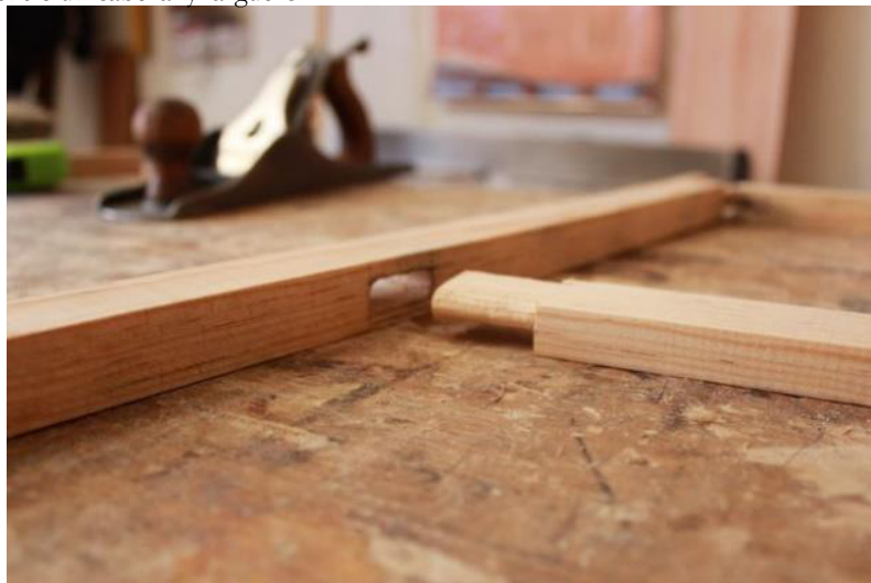
Fig. 59 Área del ensamble en caja y espiga entre larguero y travesaño. Fotografía de Elizabeth Vite
