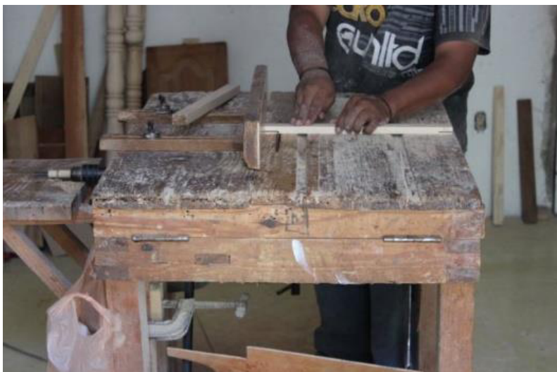
Fig. 51 Factura de una de las espigas del travesaño. Fotografía de Elizabeth Vite
