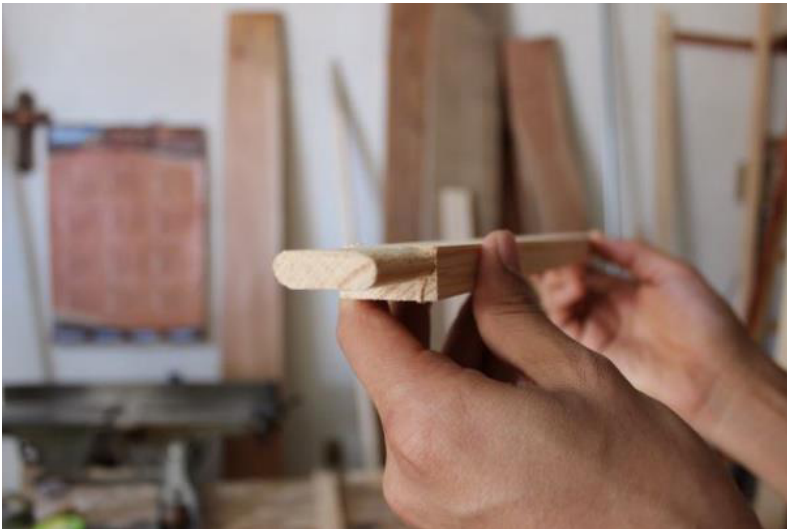
Fig. 56 Espiga del travesaño. Fotografía de Elizabeth Vite
