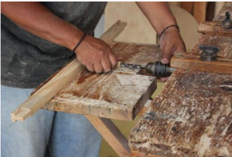
Fig. 50 Horadación de un larguero para hacer la caja para travesaño. Fotografía de Elizabeth Vite
