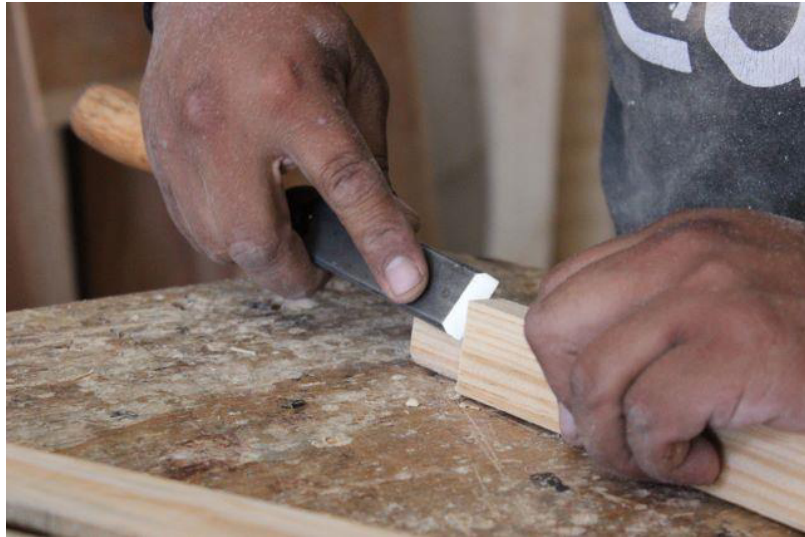
Fig.53 Uso de formón para precisar la espiga del travesaño. Fotografía de Elizabeth Vite
