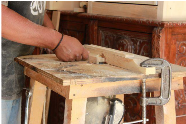
Fig. 47 Corte en forma de "T" en los extremos de un larguero. Fotografía de Elizabeth Vite
