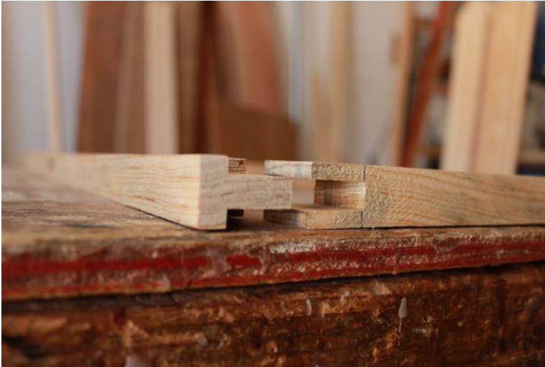
Fig. 58 Área del ensamble en “T” entre un cabezal y larguero. Fotografía de Elizabeth Vite
