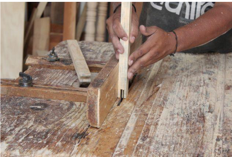
Fig. 48 Corte de la horquilla en los extremos de un cabezal. Fotografía de Elizabeth Vite
