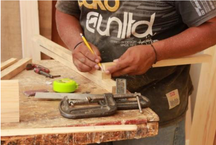
Fig. 46 Medición y marcado para hacer los cortes. Fotografía de Elizabeth Vite
