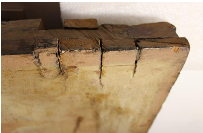
Fig. 151 Reparación de la zona superior izquierda del bastidor, vista del frente. Fotografía Elizabeth Vite.
