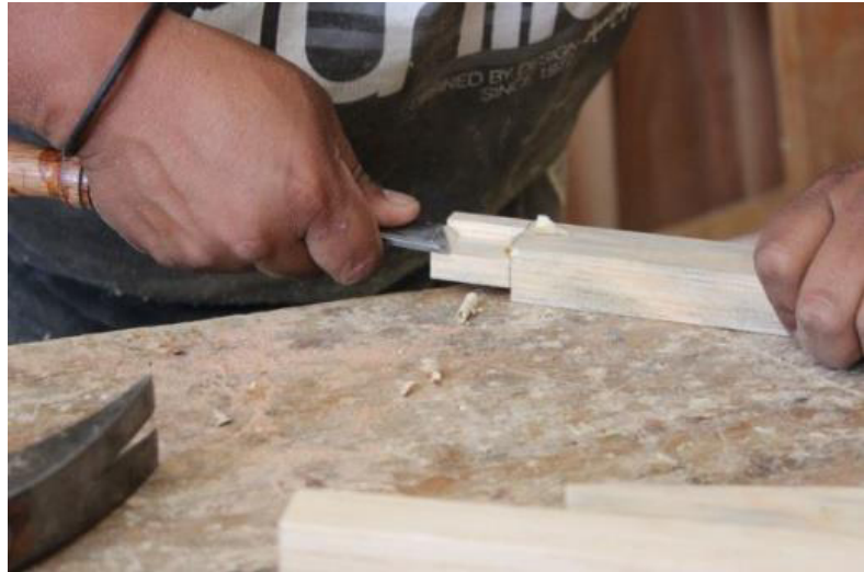
Fig. 49 Uso del formón para precisar corte en “T”. Fotografía de Elizabeth Vite
