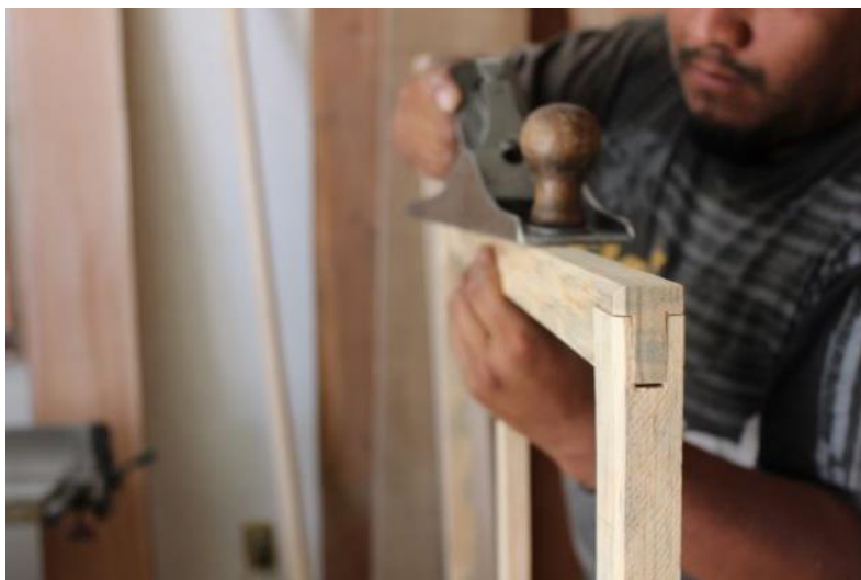
Fig. 61 Cepillado del canto externo del bastidor. Fotografía de Elizabeth Vite
