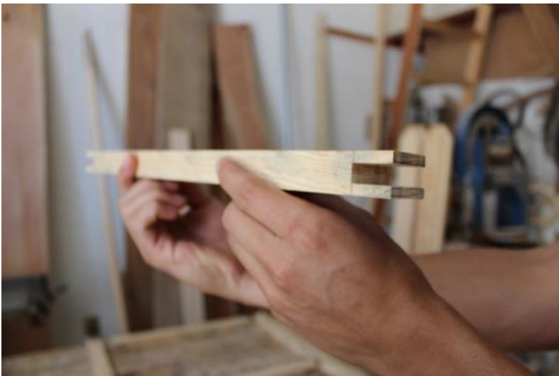
Fig.53 Uso de formón para precisar la espiga del travesaño. Fotografía de Elizabeth Vite
