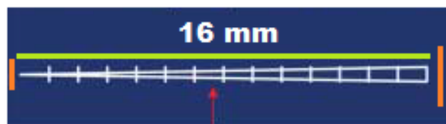
Fig. 31 Forma cónica de la parte activa de una lima.
