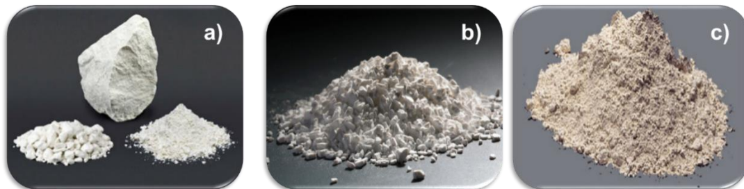
Figura 1 Composición de la porcelana. a) Caolín. b) Sílice. c) Feldespato de potasio. 3
