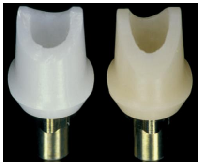
Figura 47 Comparación entre aditamento de zirconia (izquierda) y alúmina (derecha).
