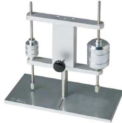
Fig 3. Aparato para prueba de fraguado. Gilmore.
