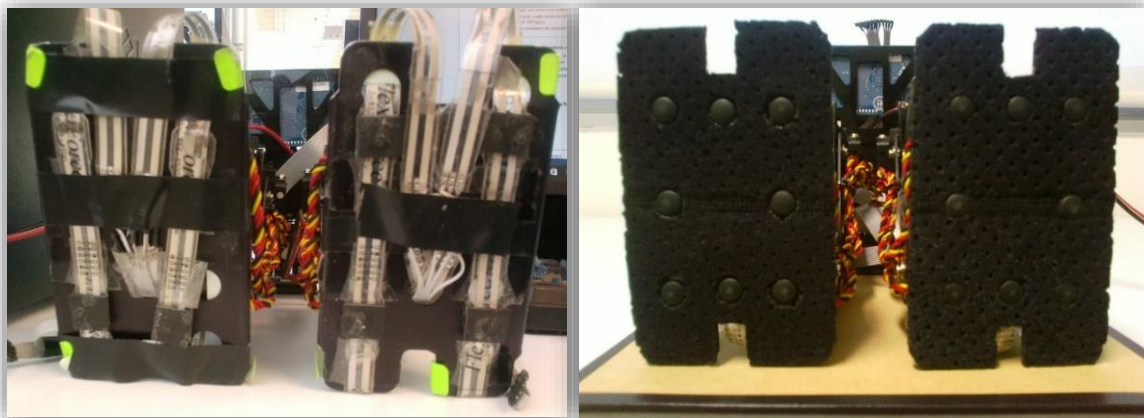
Figura 5.28. Sensores de fuerza iniciales (izquierda). Plantillas implementadas (derecha).
