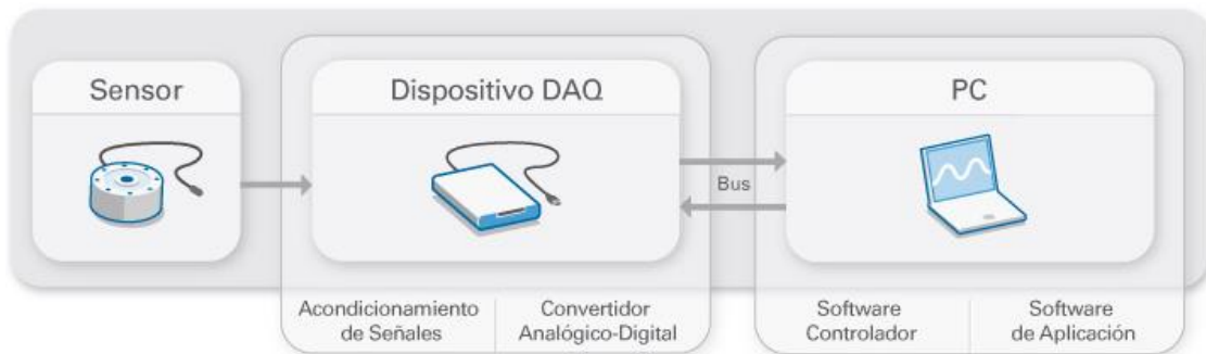
Figura 3.14. Partes de un sistema DAQ.
