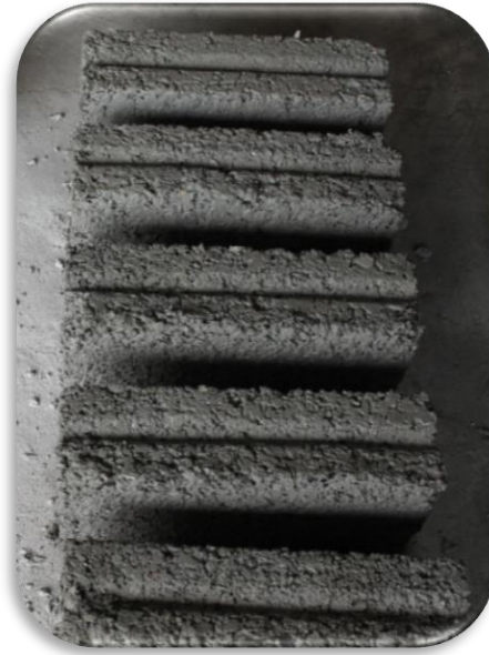
Figura 4.7 La imagen es la manera en que se dispusieron los tabicones fabricados para proceder con los riegos durante el proceso de fraguado del concreto elaborado con la mezcla de cemento arena y PET.
