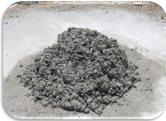
Figura 4.1 Mezcla de PET, Cemento, Arena y Agua; la mezcla no presenta una homogeneidad se observan algunos grumos y el agua se separa de la revoltura, las pruebas de revenimiento y contenido de humedad no fueron del todo satisfactorias, como se menciona en la Tabla 4.1.
