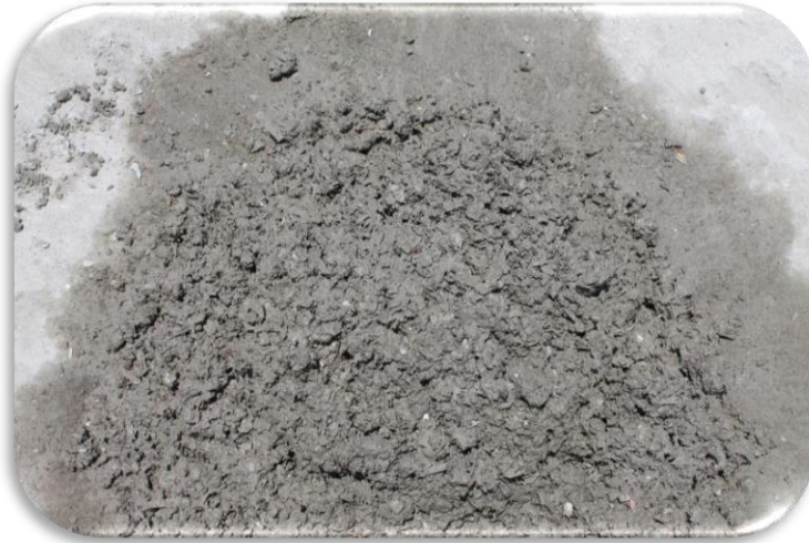
Figura 4.2 La imagen es la de la mezcla PET, Cemento, Arena, Cal y Agua; ahora la revoltura es homogénea se pueden observar algunos grumos sin embargo las pruebas de revenimiento y de contenido de humedad son bastante buenas, se facilita el llenado del molde y al mover la mezcla el agua se queda en ella y no se separa.
