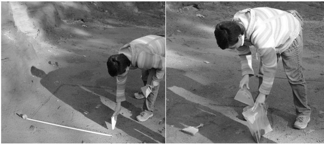
Figura 3. Toma de muestra de suelo superficial
