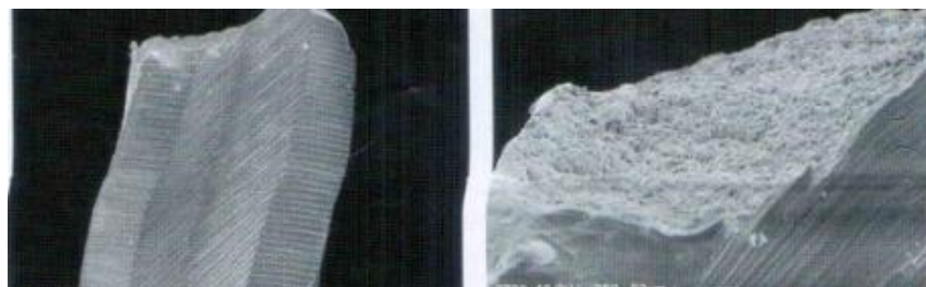
Fig. 14a Fractura de fatiga. Poco o ningún tipo de deformación
