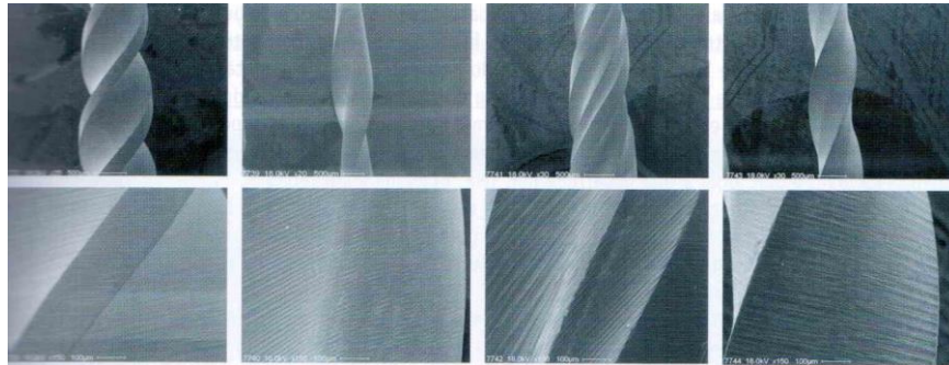
Fig. 22 Imágenes microscópicas de las superficies de los instrumentos Profile, Mtwo,K3, Protaper Universal en la que se observan las marcas propias de la terminación de torneado.
