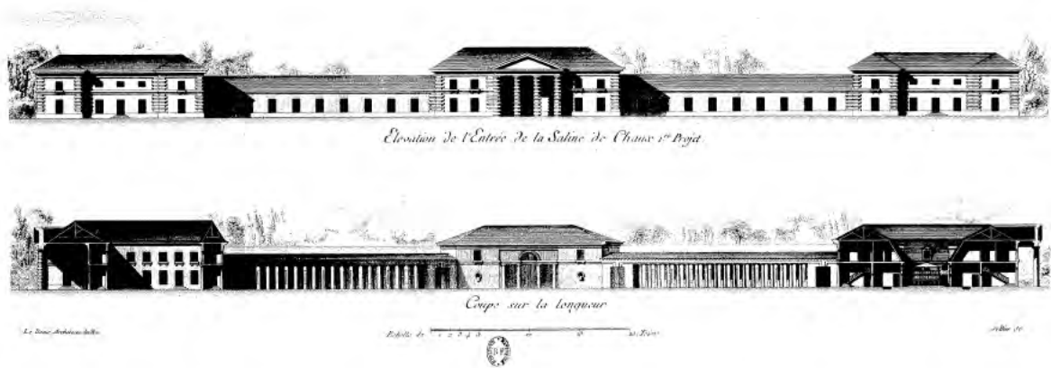
Fachada del acceso y corte longitudinal del primer proyecto de Ledoux para la Salina de Arc-et-Senans. Bibliothèque nationale de France.
