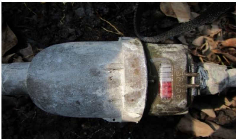
Figura 16: Medidor volumétrico de pistón oscilante, instalado para medir riego.
