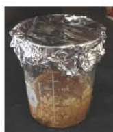
Figura E.7. Extracción de CPD con disolvente MAC-141
