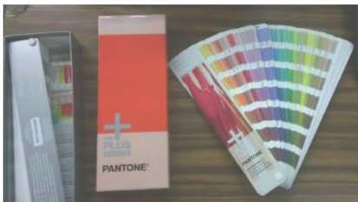
Figura A.25. Escala Pantone® empleada para la determinación de color en la superficie de los higos y las uvas
