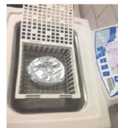
Figura E.6. Sonicación del CPD con disolvente MAC-141
