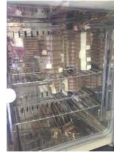
Figura E.20. Incubación de pruebas para mesofílicos aerobios
