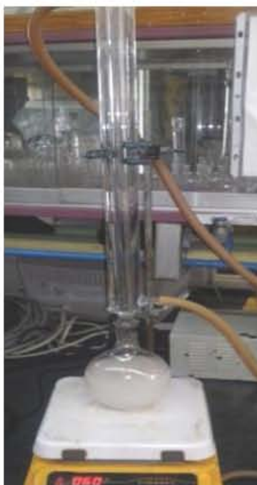
Figura A.10. Reflujo para la síntesis del disolvente MAC-141©
