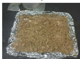
Figura E.3. Secado del cefalotórax-exoesqueleto parcialmente desproteínizado, CPD
