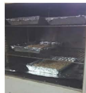
Figura A.8. Secado del CPD en horno de convección a 60°C/20h
