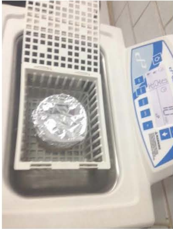
Figura A.12. Sonicación del CPD con disolvente MAC- 141
