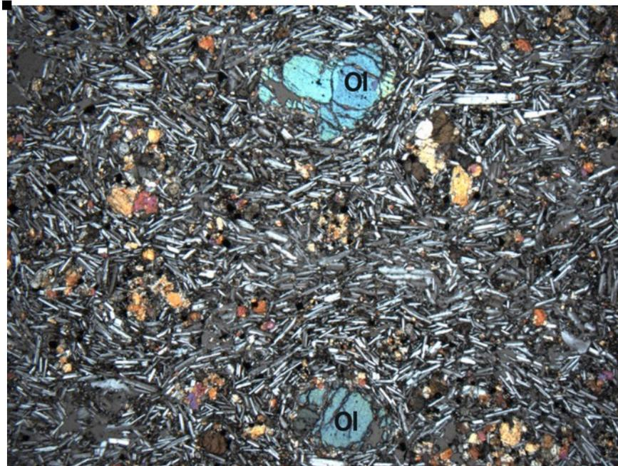
*Fig. 65. Muestra ALJ-BAS, correspondiente a la lava pre maar, compuesta de microlitos de Pl, y Px, fenocristales de Ol y Cpx.*
