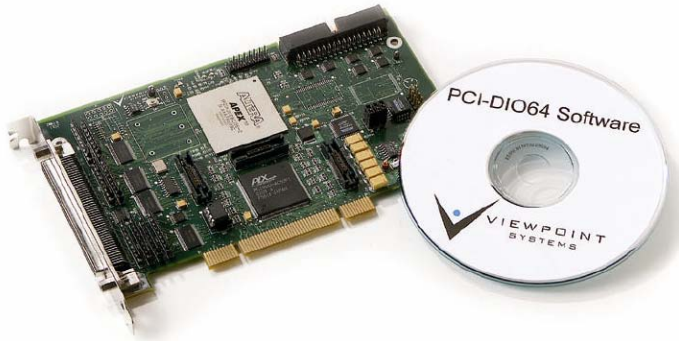
Figura 5.2: Tarjeta de control de eventos DIO64.
