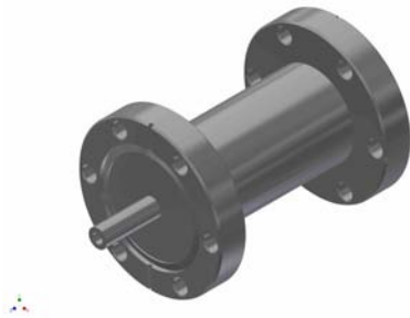
Figura 4.16: Bombeo diferencial I.
