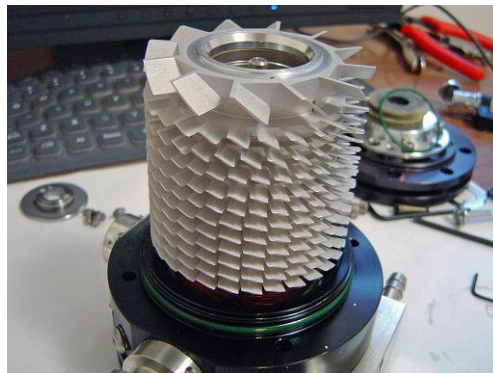
Figura 4.31: Arreglo de rotores en una bomba turbomolecular (imagen tomada de [61]).
