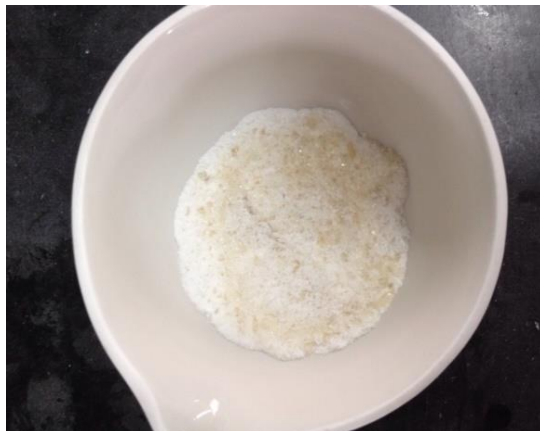
Figura 19 LTV inmovilizada usando una técnica de sol-gel con PTMS
