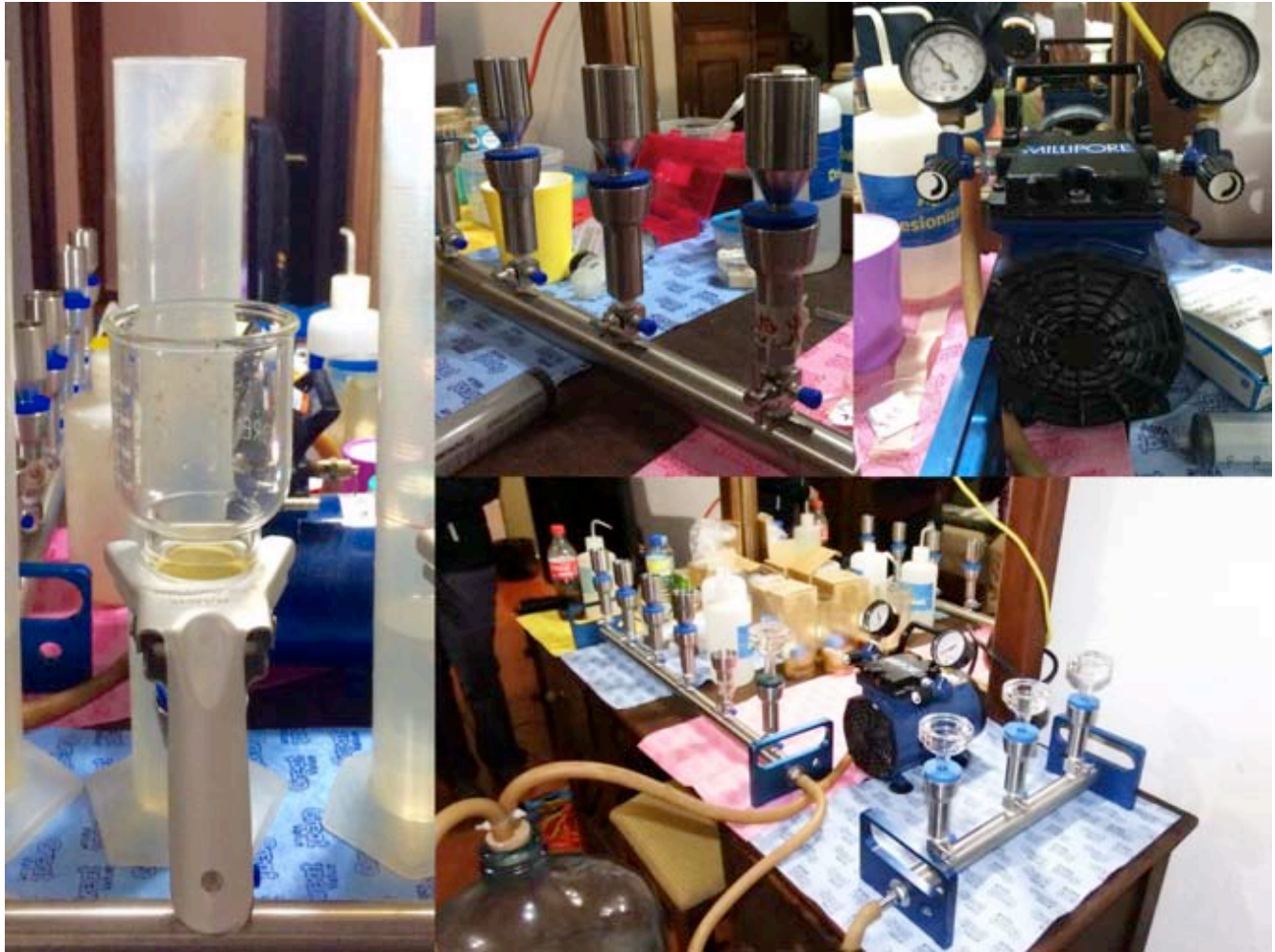
Figura 5. Equipo de filtración Millipore.
