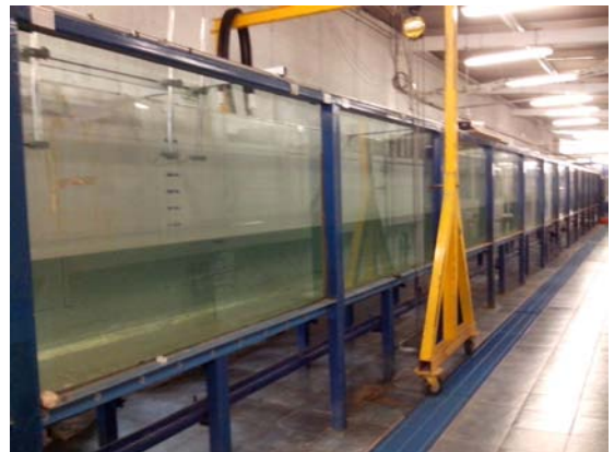
Figura 4.1: Canal de oleaje del Laboratorio de Costas y Puertos, UNAM.
