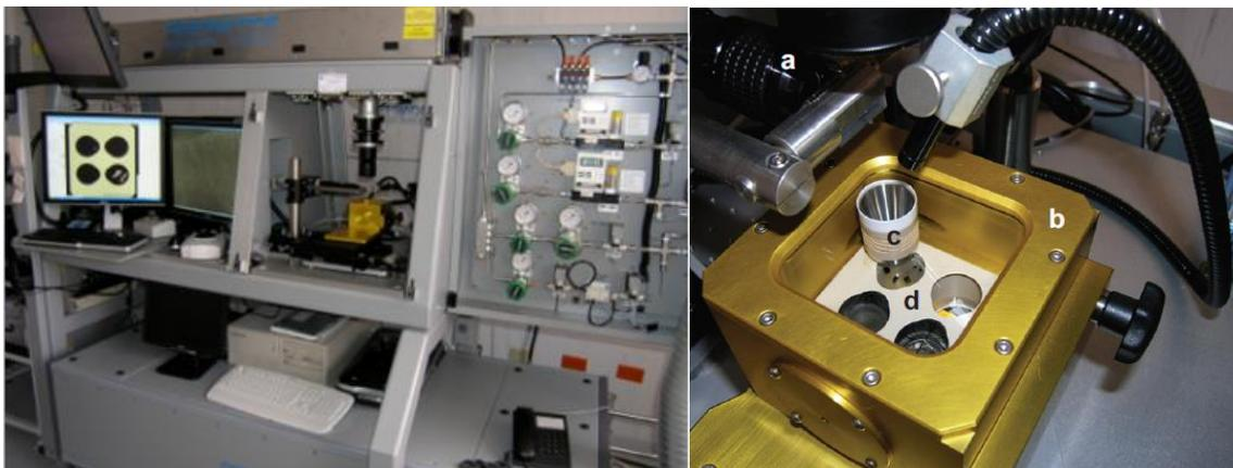
Figura 3.I. a) Equipo de ablación láser integrado a un espectrómetro de masas cuadrupolar (LA-ICP-MS-MC) del Centro de Geociencias de la UNAM. b) Detalle de la cámara de lentes, a 90° del láser, con las muestras montadas. (Modificado de la página del Centro de Geociencias y de Solari *et al.*, 2009).
