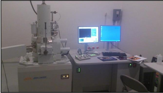
Figura 27.1 Microscopio Electrónico de Barrido
