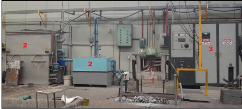
Figura 18.1 Horno de inducción sin núcleo.
