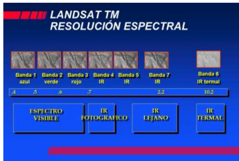
Imagen 3.9 Imagen que muestra las distintas resoluciones espectrales que tienen las siete bandas de un satélite Landsat que toma imágenes satelitales. Fuente: http://slideplayer.es/slide/1727983/ .
