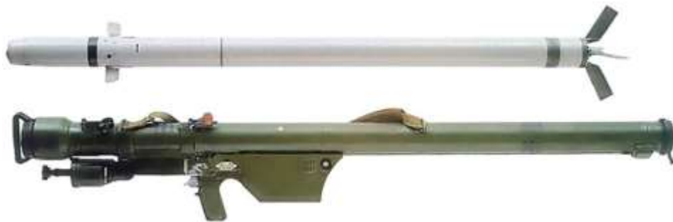
Imagen 3.20 Fotografía del misil antiaéreo y lanzador SAM Strela, el cual tiene una guía infrarroja, por lo cual es un misil que se le conoce por "dispara y olvida", debido a que una vez fijado en su objetivo debido al infrarrojo que contiene, seguirá a su objetivo aunque este esté en movimiento. Fuente: http://www.zona-militar.com/foros/threads/artilleria-anti-aerea.1769/ .
