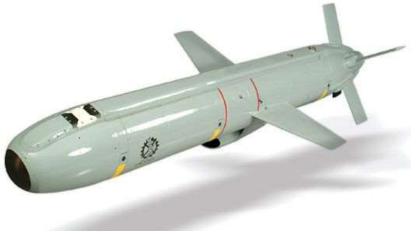
Imagen 3.12 Fotografía de un misil Tomahawk, en la cual se observa la cámara infrarroja con la cual pueden observar en tiempo real el terreno y poder modificar su plan de vuelo en el momento necesario. Fuente: http://www.washingtonpost.com/wp-srv/iraq/missile.htm .
