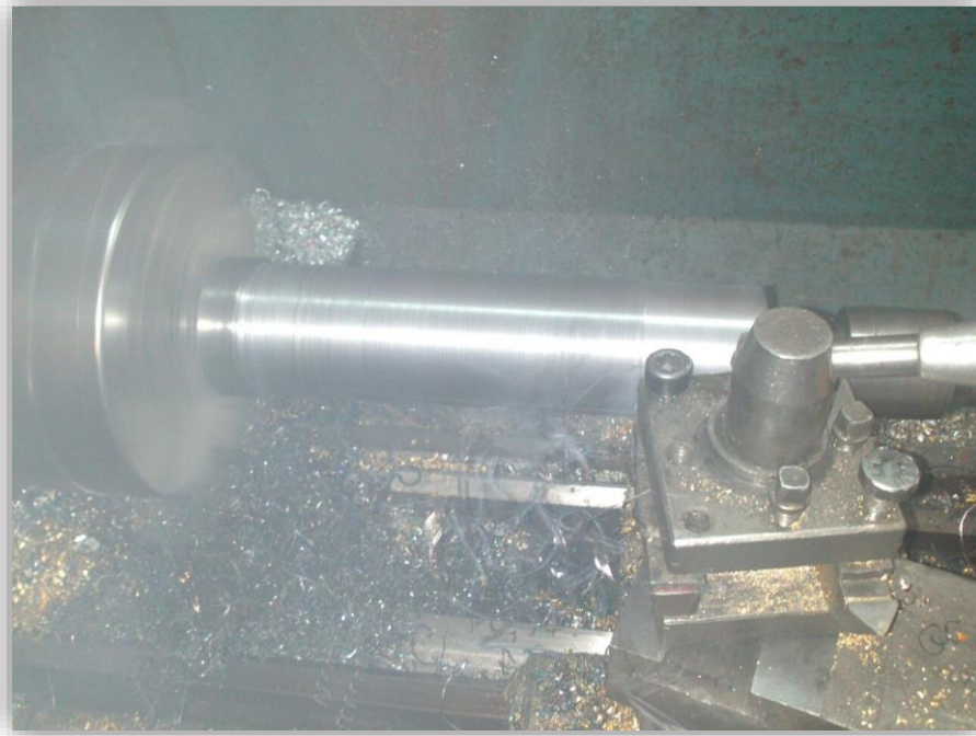
Figura 4.K. Manufactura del eje central
