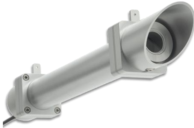
Figura D. Pirheliómetro usado para la medición de la radiación directa
