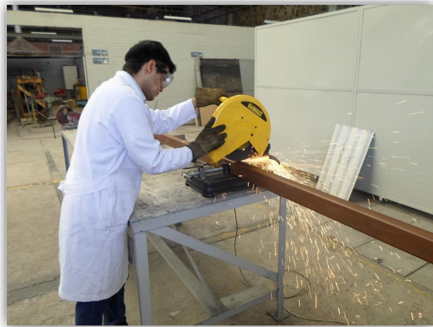
Figura 4.A. Fotografía tomada durante el corte de los perfiles de acero
