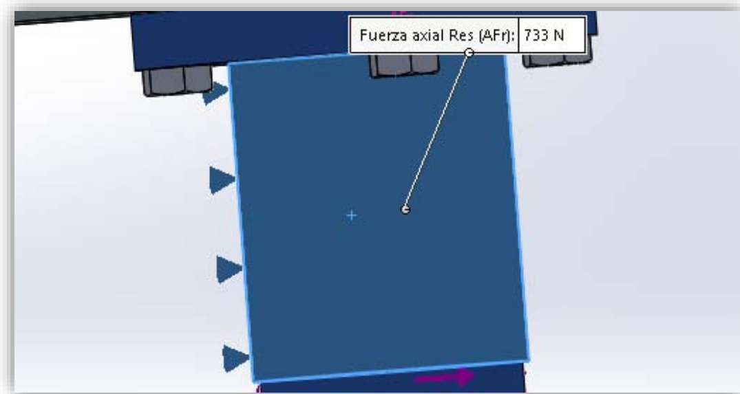
Figura 3.AG. Esfuerzo axial dado por el rodamiento radial
