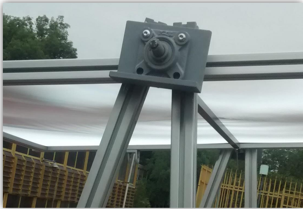
Figura 4.O. Unión de los ejes superiores con las chumaceras, los postes laterales y el marco de la lente
