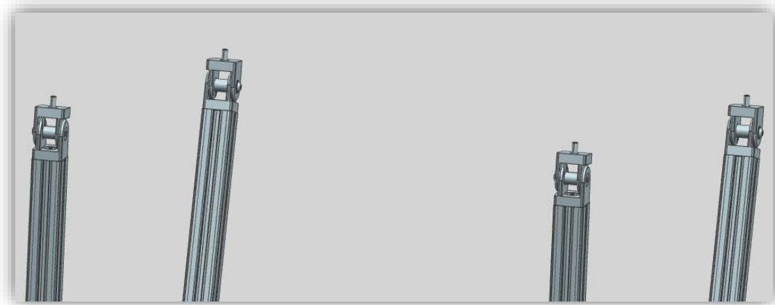
Figura 3.T. Accesorios que sirven de medio de unión entre el marco de la lente y los postes de la canasta central
