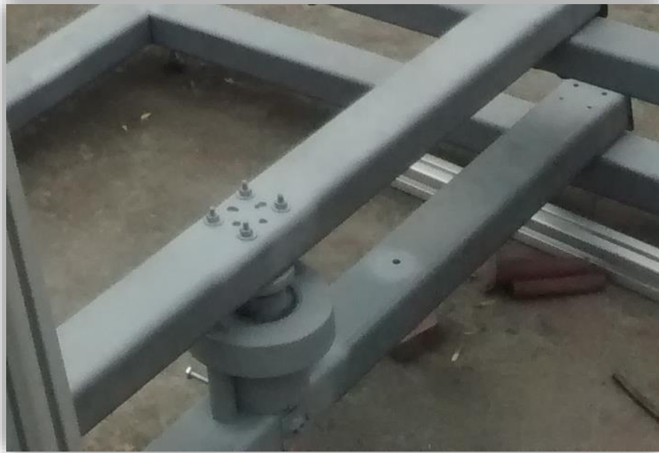
Figura 4.Ñ. Unión del eje central con los rodamientos; radial y axial
