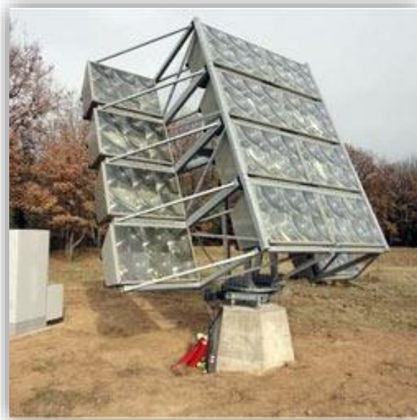
Figura G. Torre fotovoltaica de alta concentración
