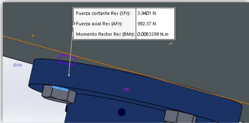
Figura 3.AN. Tornillo donde se encuentran la fuerza cortante de mayor intensidad
