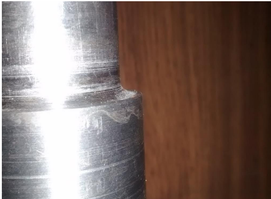
Figura 4.M. Chaflán del eje previo al acabado de la pieza
