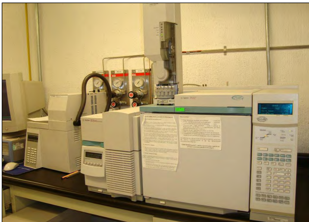
Figura 3. Cromatógrafo de gases Agilent (HP6890) equipado con un detector de masas (HP5973).
