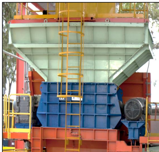
Figura 5.38 Tolva de recepción
