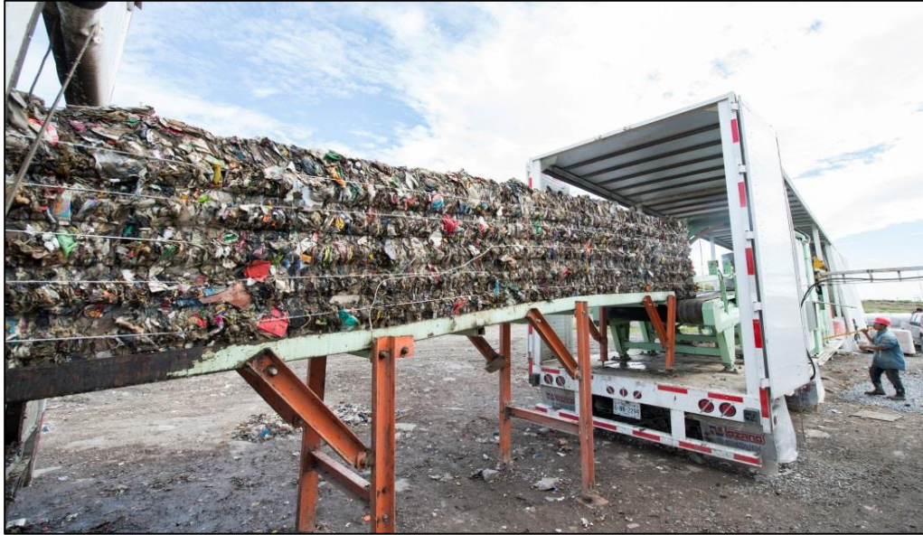
Figura 2.8 Compactación y atado de la FIRSU Fuente: (ICR, 2014)
