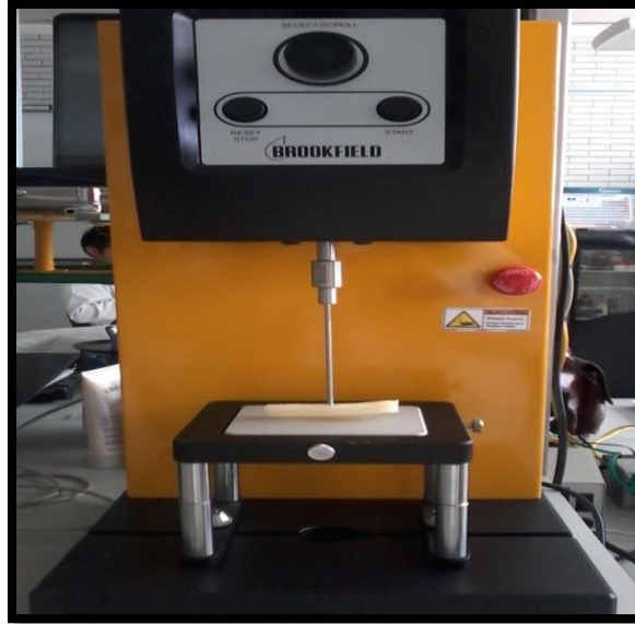
Figura 21. Texturómetro Brookfield penetrando papa escaldada y congelada.
