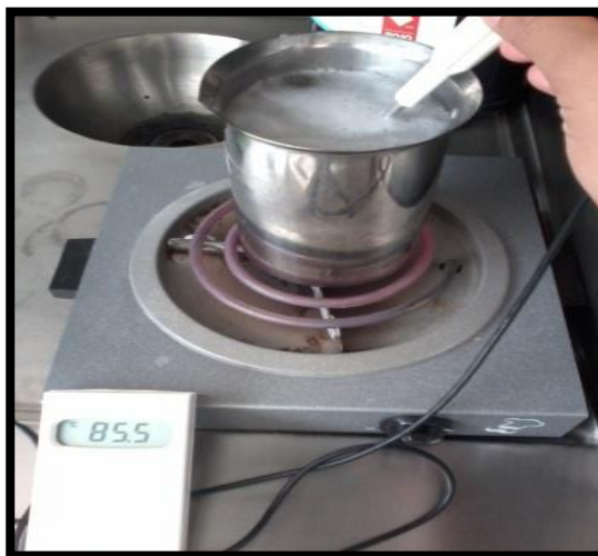
Figura 16. Escaldado de cada corrida según el diseño experimental.
