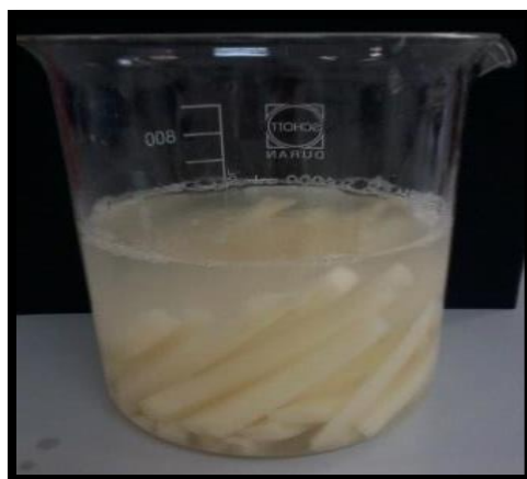
Figura 15. Acondicionamiento de la muestra en la solución de NaCl y CaCl 2
