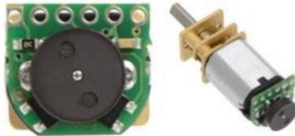
Imagen 2.9 Encoder magnético y micro-motorreductor POLOLU.
