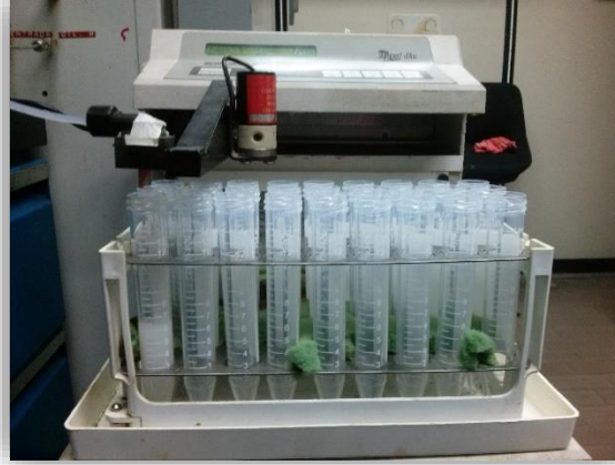
Fotografía 9 Recolección de volumen de aceite y salmuera durante recuperación secundaria
