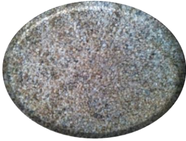
Fotografía 1 Arena de Caletilla mallado 35-60
