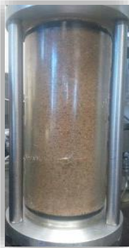
Fotografía 4 Empacamiento 1 con arena de Caletilla
