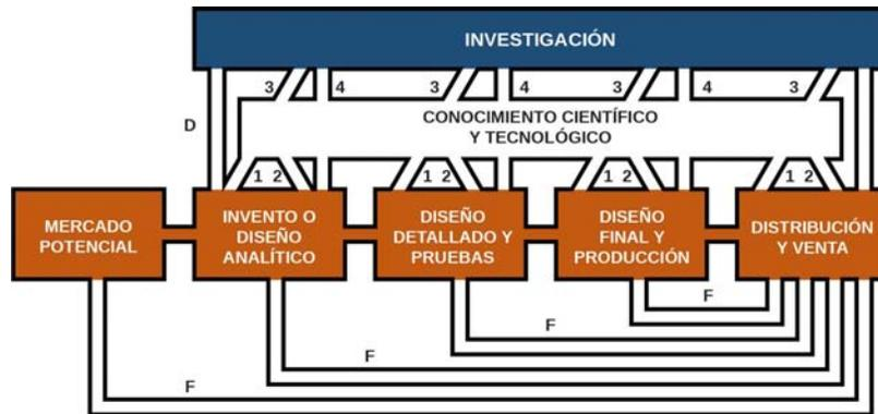
Figura 1.5: **Modelo de Cadena-Eslabón**
