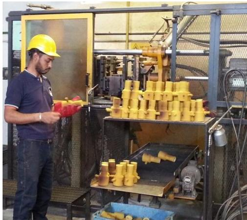
*Ilustración 13.* Inspección de Calidad a corazones. (2013). Recuperado de <http://www.foundry-shell-casting.it/en/>
