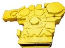
*Ilustración 7.* Corazón Shell. Recuperado de <http://4.imimg.com/data4/LM/XO/MY-9591886/shell-core-500x500.jpg>
