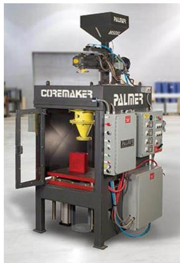
*Ilustración 2.* Sopladora de Corazones Autofraguantes Palmer CoreMaker™ Serie-CM (2016). Recuperado de <http://www.palmermfg.com/images/img18F.jpg>
