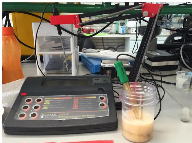
**Figura 17.** Medición de pH con el potenciómetro.
