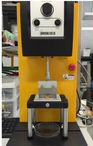
**Figura 22.** Corte de la muestra en el texturómetro Brookfield.
