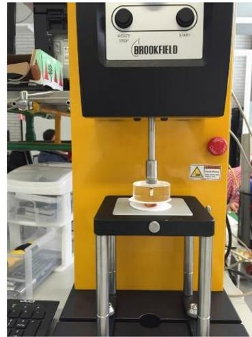
**Figura 23.** Compresión de la muestra en el texturómetro Brookfield.
