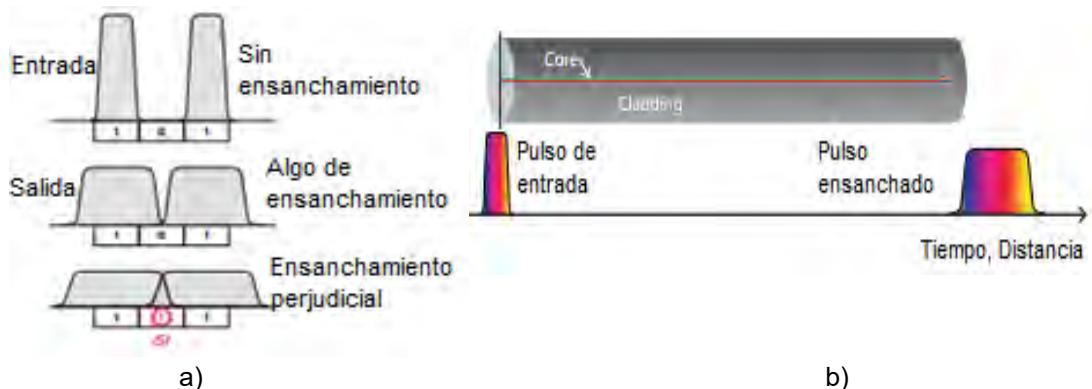
Figura 1.3. a) Interferencia intersimbólica debida a ensanchamiento. b) Diferentes longitudes de onda viajando a diferentes velocidades. [10].
