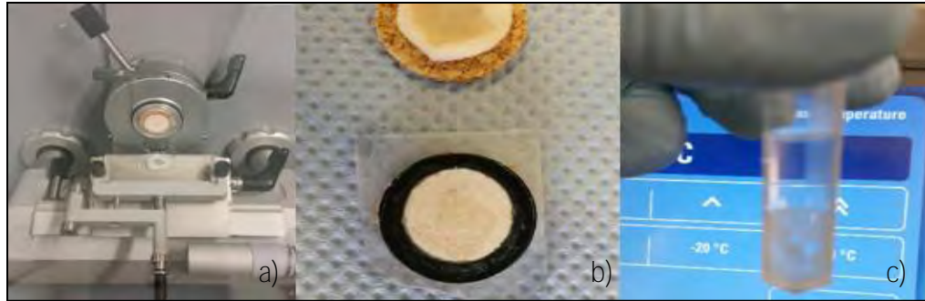
Figura 17. a) Corte de secciones de piel utilizando el criotomo, b) Preparación de muestra de piel, c) Extracción de PAX a partir de las secciones de piel.
