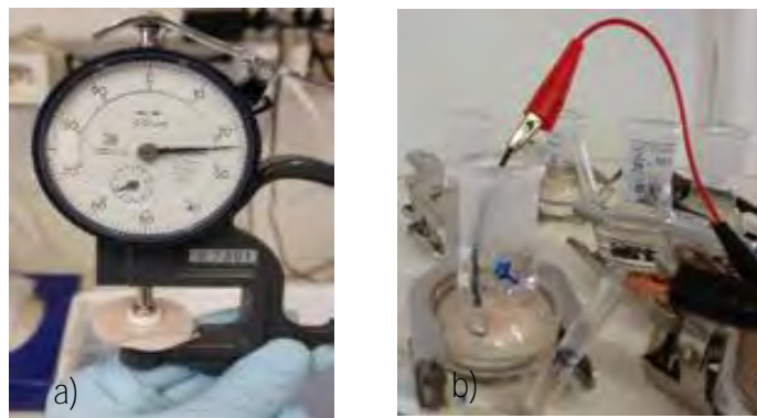
Figura 14. a) Medición del grosor de la piel, b) Medición de la resistencia eléctrica de la piel
