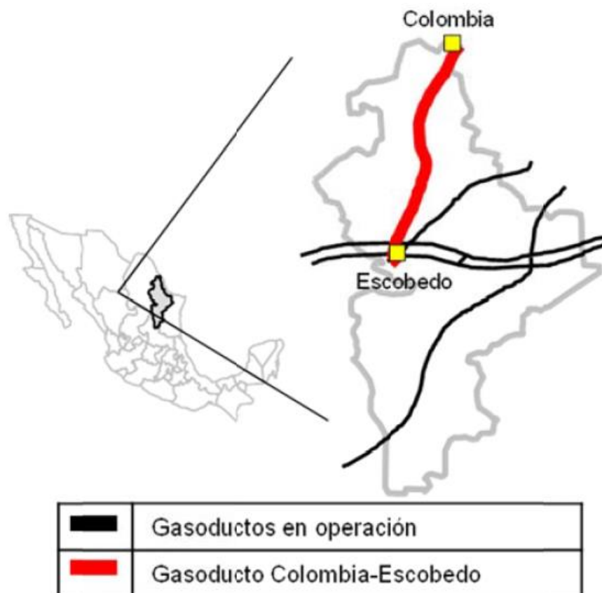
Fig. 9.17 Gasoducto Colombia–Escobedo (Diámetro: 30 pulgadas, Longitud: 300 kilómetros, Operación Comercial: 2018).
