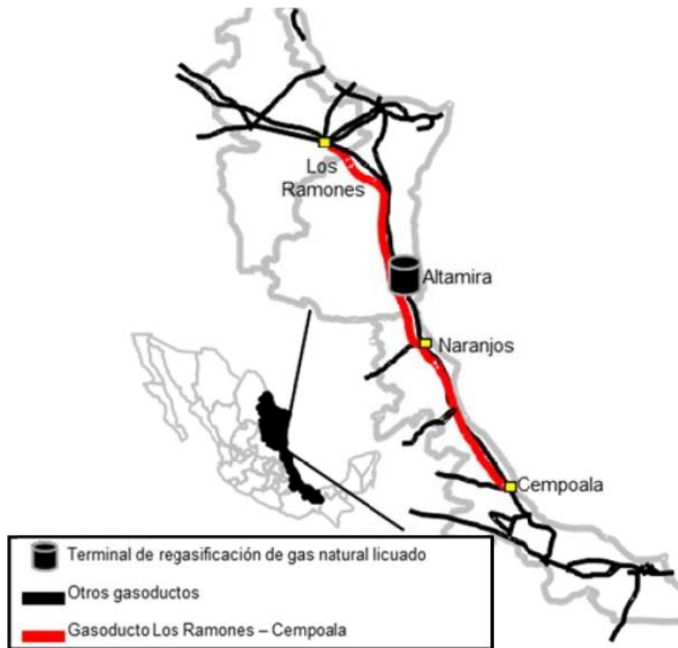
Fig. 9.18 Gasoducto Los Ramones–Zempoala (Diámetro: 36 pulgadas, Longitud 855 kilómetros, Operación Comercial: 2019).
