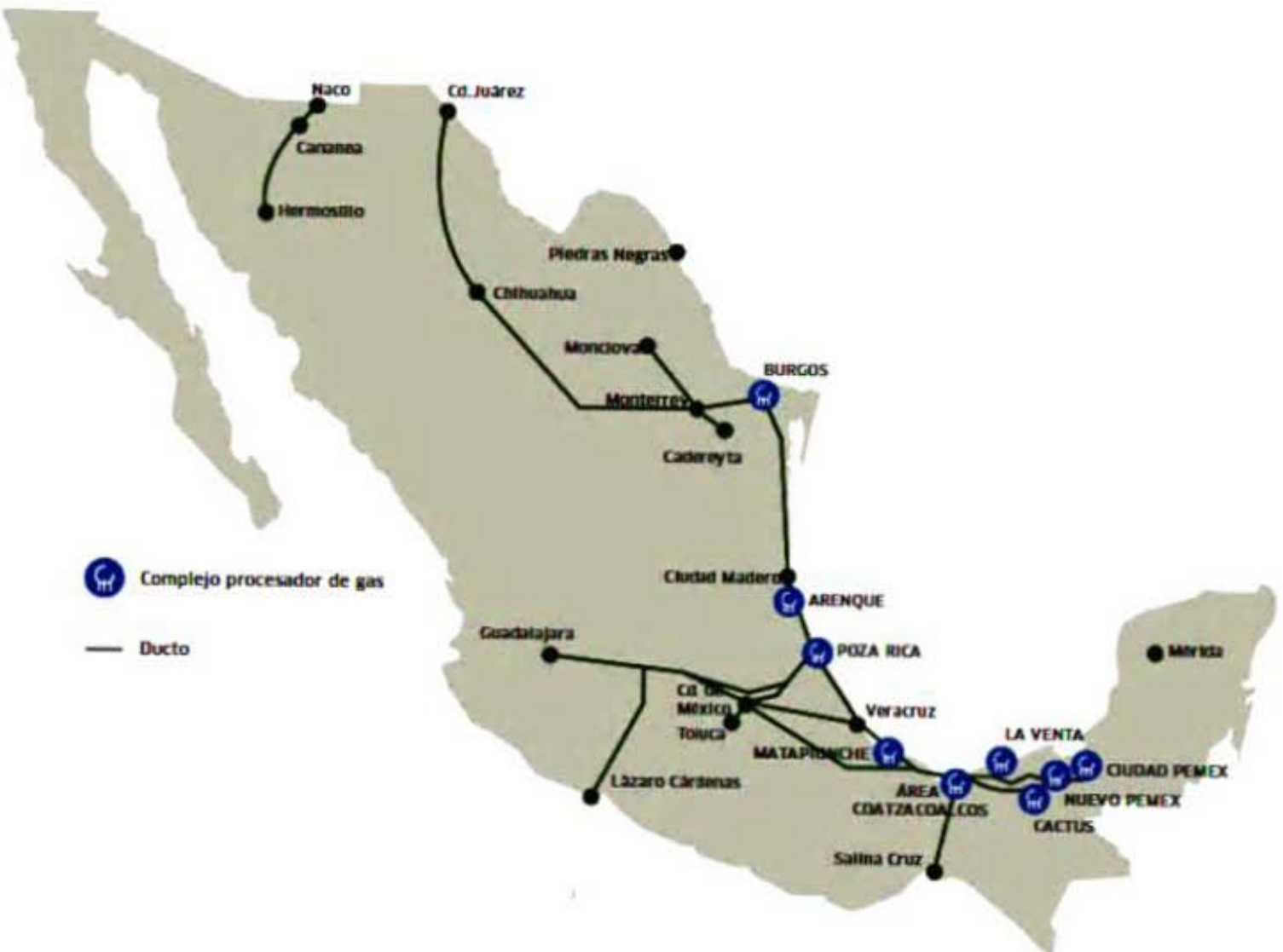
ANEXO 5. Mapa de la Red de Transporte de Gas Natural de 2013 en México.
